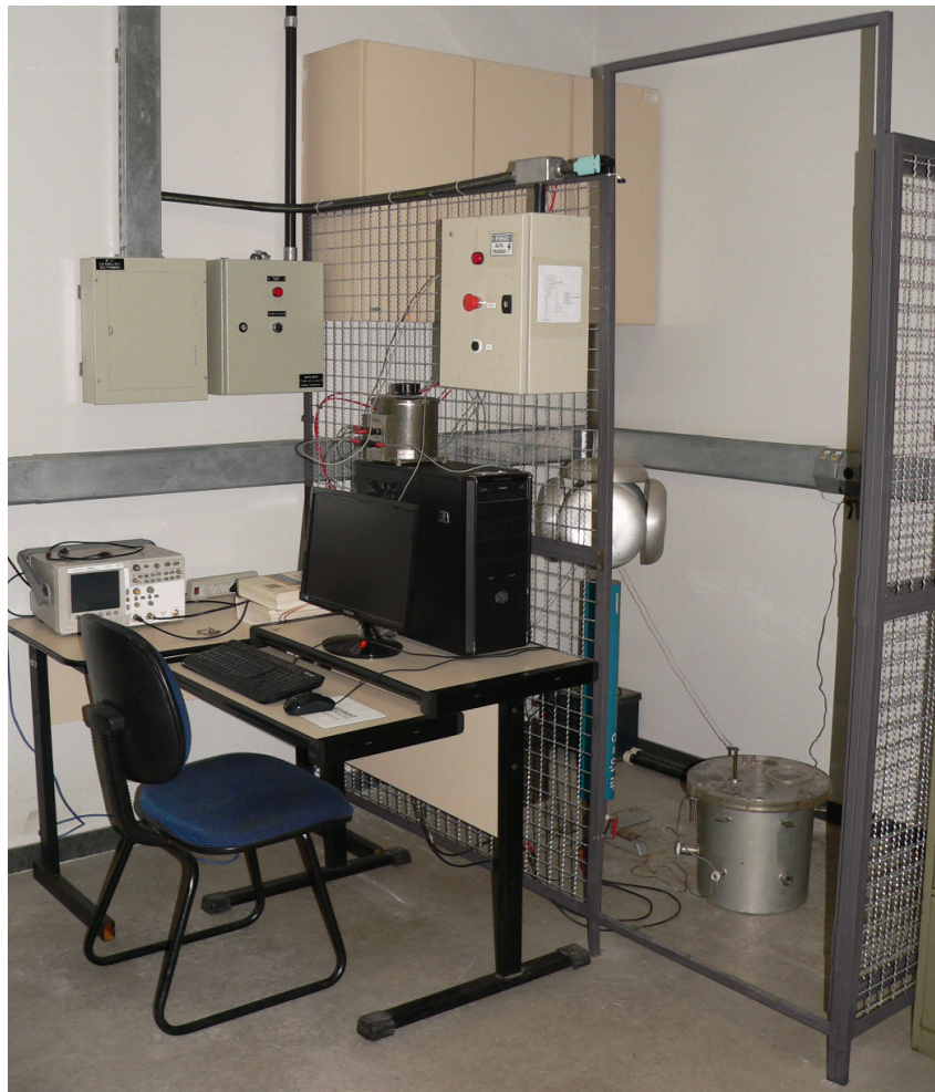
Figura 4.6: Planta de medição de Descargas Parciais
