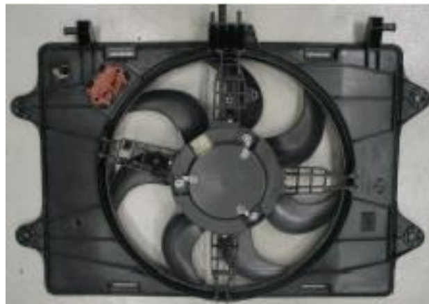
FIGURA 2.4: Eletro-ventilador do sistema de arrefecimento do motor de um veículo
