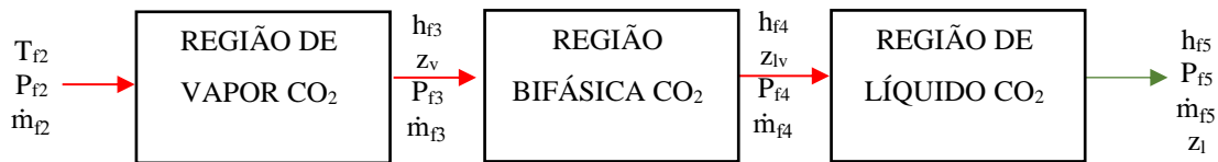
Figura 3.11: Diagrama de blocos do escoamento do CO 2 , em ciclo subcrítico.
