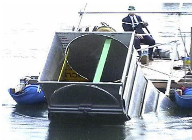
FIGURA 3.6 - Rotor hidrocínético com dimensões de 1,2 x 1,2 m envolvida com difusor. FONTE - (Kirke, 2011).
