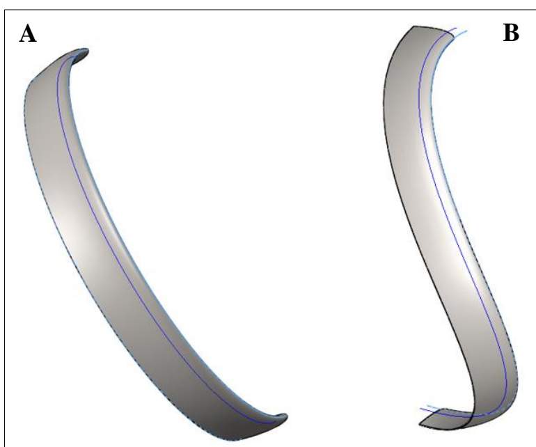
FIGURA 5.4 - Linha principal para o desenvolvimento das pás dos rotores LucidPipe (A) e esférico-helicoidal (B). FONTE – PRÓPRIO AUTOR.
