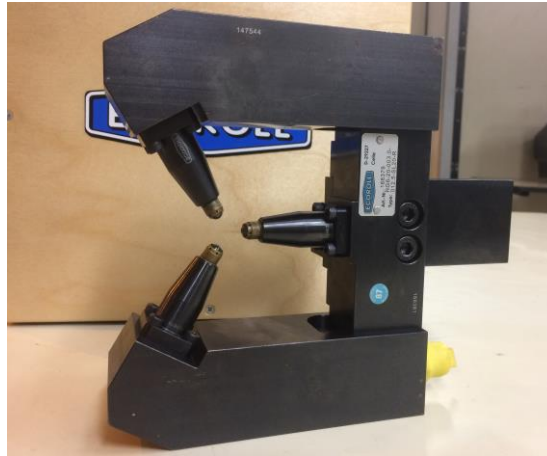
FIGURA 3.5 - Ferramenta empregada nos ensaios de roleteamento.
