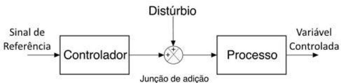
FIGURA 6 - Sistema de malha aberta.
