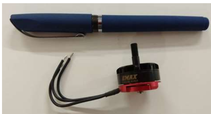
FIGURA 12 - Tamanho do motor Emax RS2205 comparado com uma caneta.
