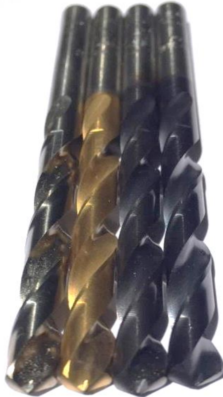
FIGURA 3.5 - Brocas aço rápido ABNT M2 6,00mm sem revestimento, revestida com TiN, TiAlN e TiAlN multicamadas respectivamente da esquerda para a direita.
