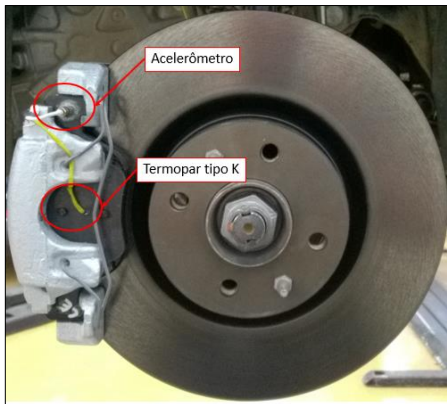
Figura 4.9: Instrumentação no freio dianteiro para teste de ruído em veículo
