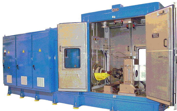
Figura 4.1: Dinamômetro inercial para freio veicular. (Fonte: www.linkeng.com )
