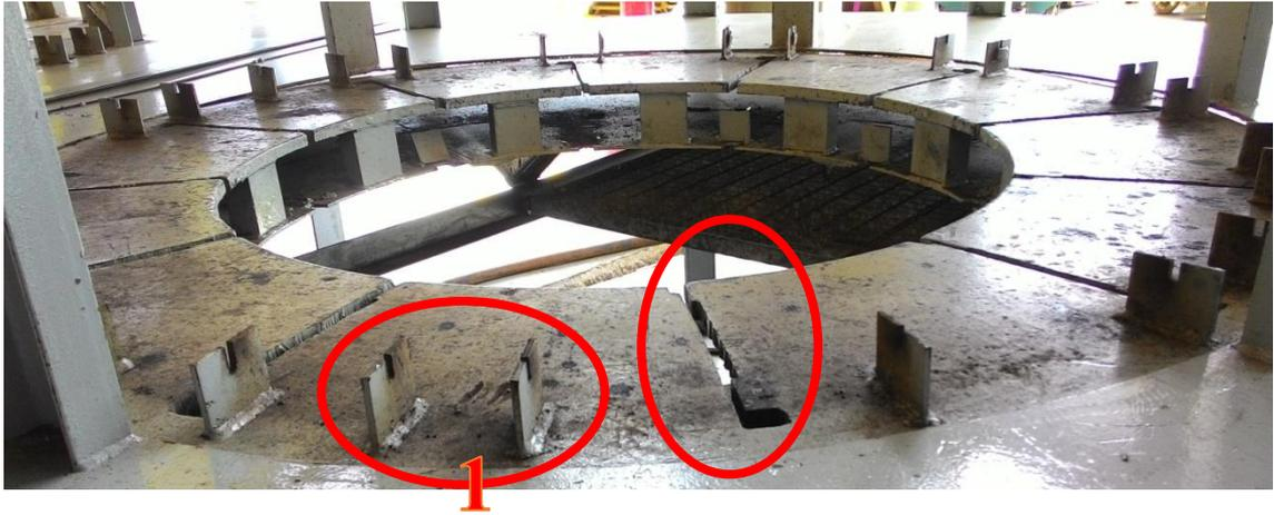
Figura 16 - as **2** fendas de encaixe acima mostram a estação de costelas esquerdas (1). Os gabaritos retangulares (2) são os dispositivos de encaixe do back metálico, que é encaixado nas fendas centrais, permitindo sua solda na virola, que fica apoiada na parte externa, em cima dos gabaritos. Fonte: fotos tiradas pelo autor em visita a campo.
