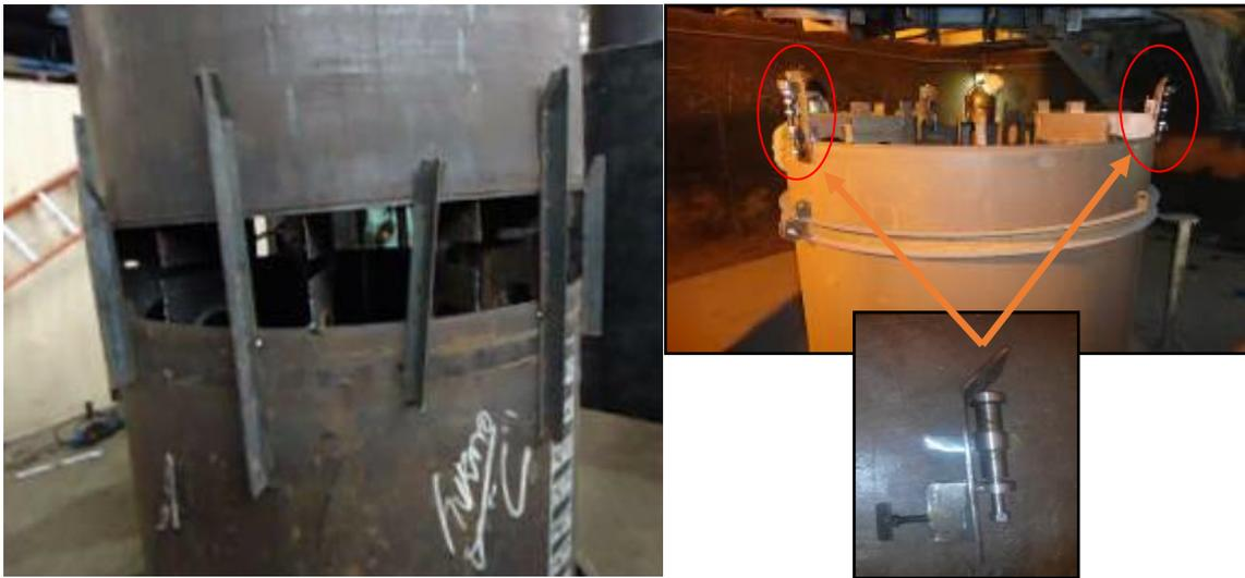
*Figura 19 - Na imagem à esquerda é possível ver o grande número de gabaritos que eram utilizados. Com a modificação da foto à direita, o encaixe do novo eletrodo foi facilitado e consequentemente o tempo foi reduzido. Fonte: primeira foto cedida do acervo do primeiro pesquisador e segunda foto tirada pelo autor em visita a campo.*
