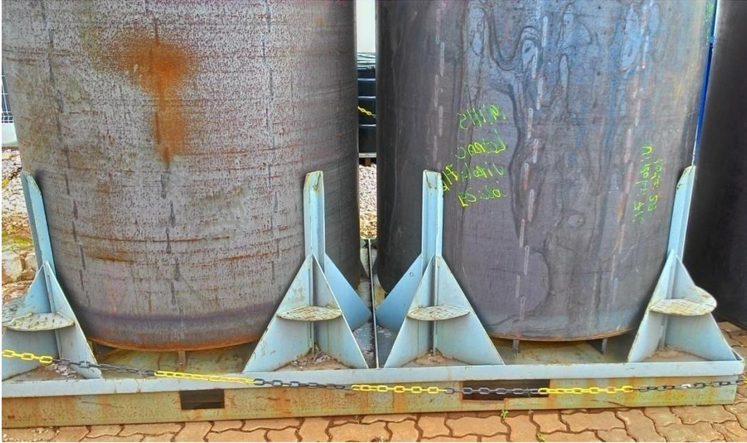
*Figura 21 - Os suportes das beiradas ajudam a dar estabilidade às virolas apoiadas, e os furos na parte inferior permitem a movimentação por empilhadeiras. Fonte: foto tirada pelo autor em visita a campo.*
