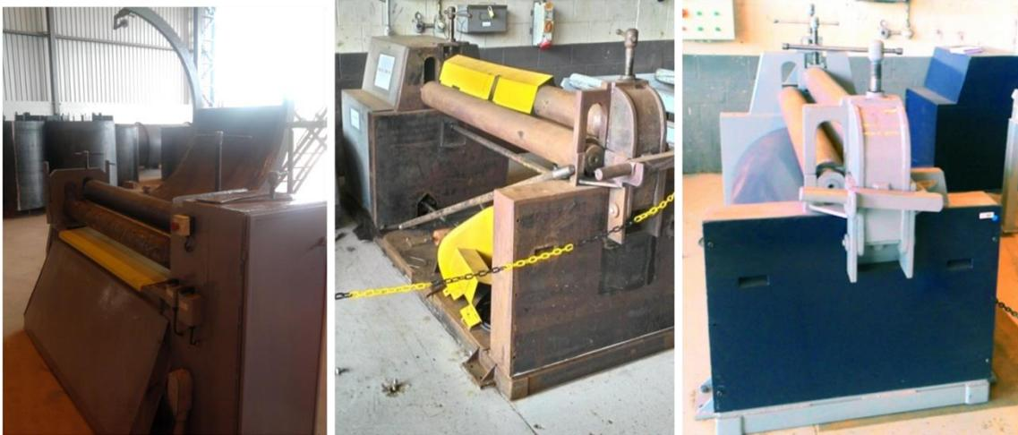
*Figura 18 - A esquerda, foto da calandra antiga. No meio, o equipamento em construção, e a direita o resultado final. Apenas os rolos permaneceram os mesmos no processo. Fonte (da esquerda para direita): primeira foto do acervo do primeiro pesquisador, segunda e terceira fotos tiradas pelo autor em visita a campo.*
