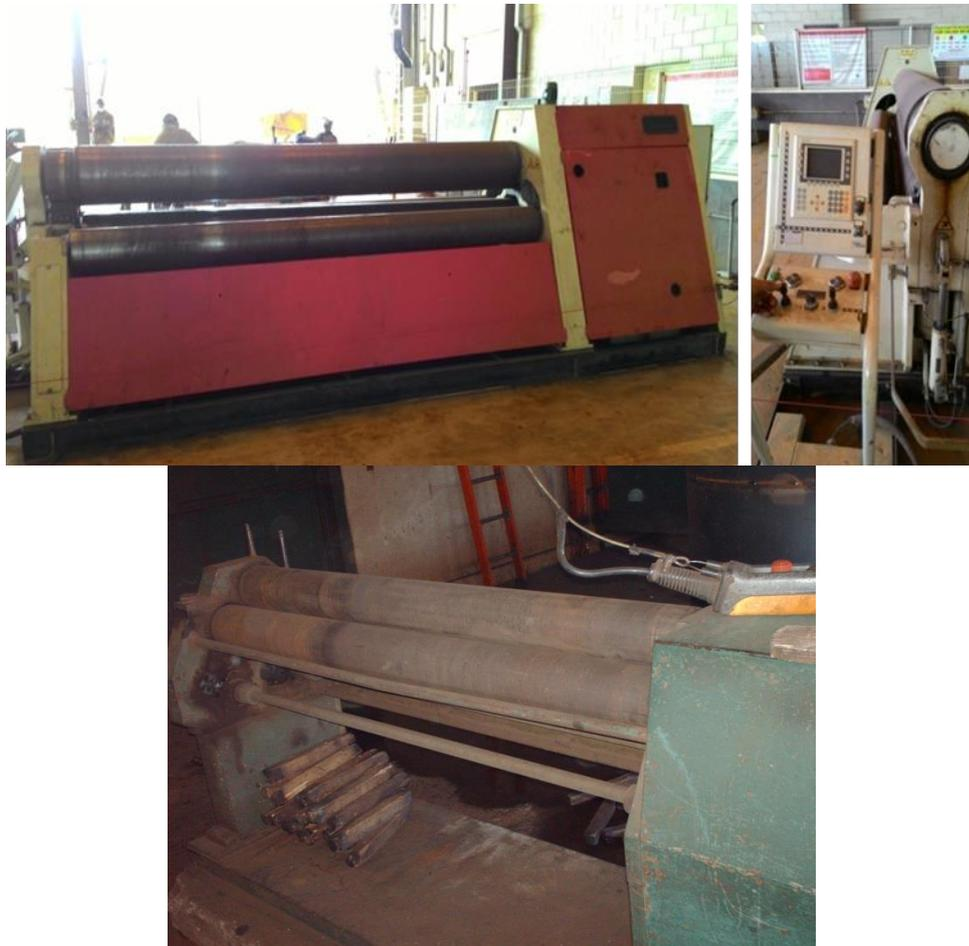
*Figura 12 -Comparativo entre as calandras da EP (primeira foto) e da EE (segunda foto). Fonte: As fotos da calandra da EP foram tiradas pelo autor em campo, enquanto a da EE foi tirada pelos operadores na visita (do acervo do primeiro pesquisador).*
