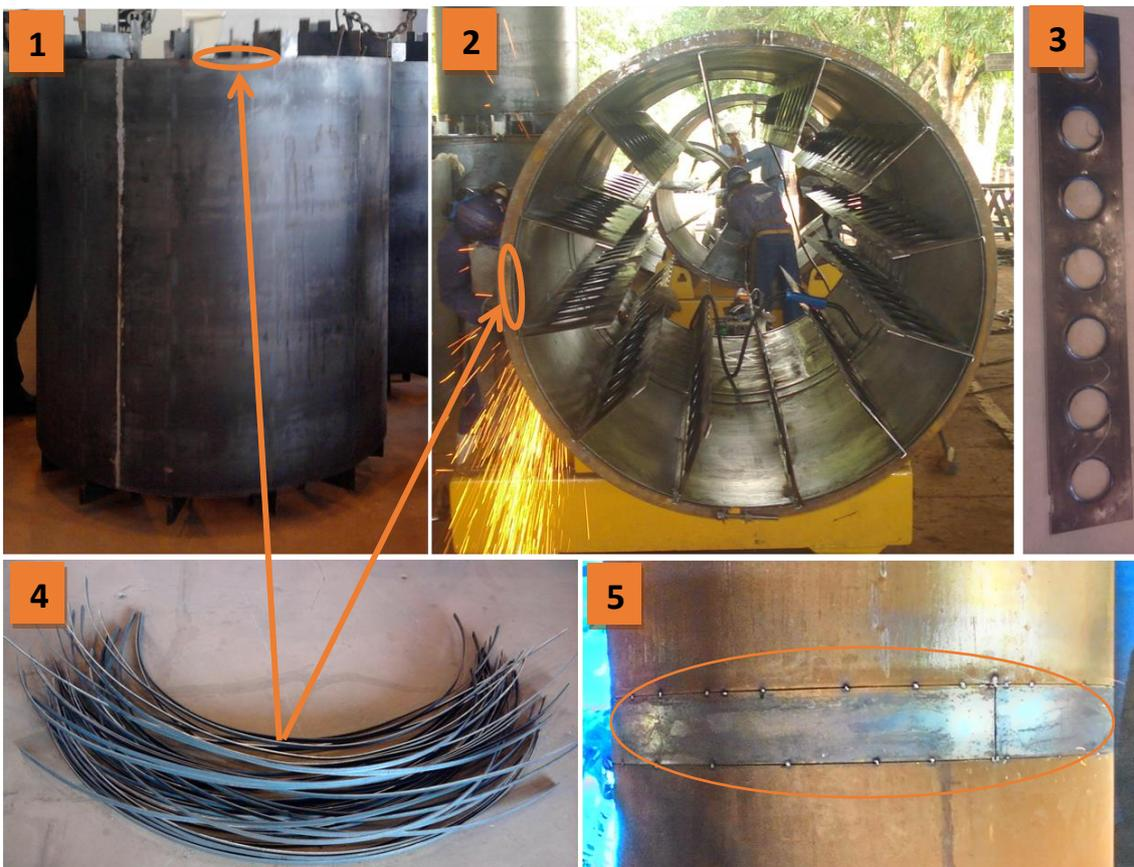
Figura 4 - Na ordem das fotos: 1) Foto de um tubo pronto 2) Vista de cima de uma virola. Nota-se as doze costelas distribuídas simetricamente dentro do tubo. 3) Foto de uma costela, com os furos/janelas estampadas na chapa de aço. 4) Estoque de back metálicos que são soldados em cada extremidade da peça. 5) Cinta de junção unindo duas virolas no alto forno elétrico. Fonte: fotos tiradas pelo primeiro pesquisador no início do projeto.
