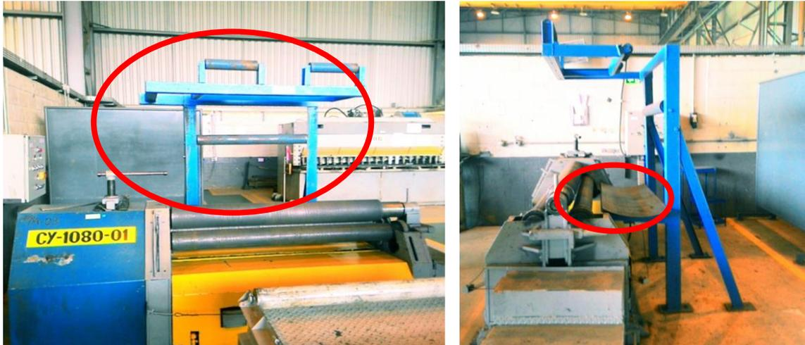
*Figura 17 - A chapa entra da esquerda para a direita nos rolos da calandra, passa pelo gabarito azul anexo, formando uma circunferência totalmente redonda, respeitando-se as restrições apertadas da virola. As partes destacadas em vermelho são as ferramentas criadas pelos operadores. Fonte: fotos tiradas pelo autor em campo*
