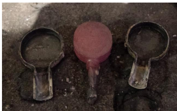
Figura 4.11 - Amostra de aço retirada durante processo de forno panela.
