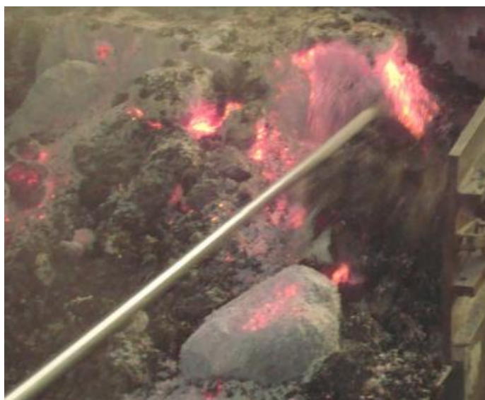
Figura 3.6 - Fabricação de escória sintética em escala industrial (CAMPOS, 2009).
