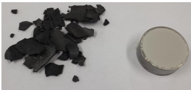
Figura 4.13 - Amostra de escória granulada e após a preparação.
