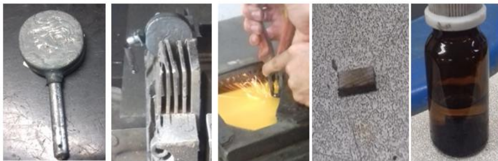
Figura 4.18 - Preparação da amostra para análise de oxigênio.
