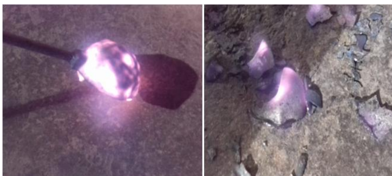
Figura 4.10 - Amostra de escória retirada ao final do processo do forno panela.
