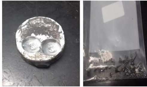
Figura 4.17 - Preparação da amostra para análise de carbono, enxofre e nitrogênio.
