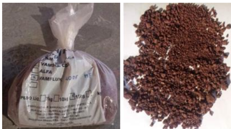
Figura 4.6 - VAMFLUX 4005 material utilizado como fonte de sílica, formulado para utilização no refino do aço GOBT.
