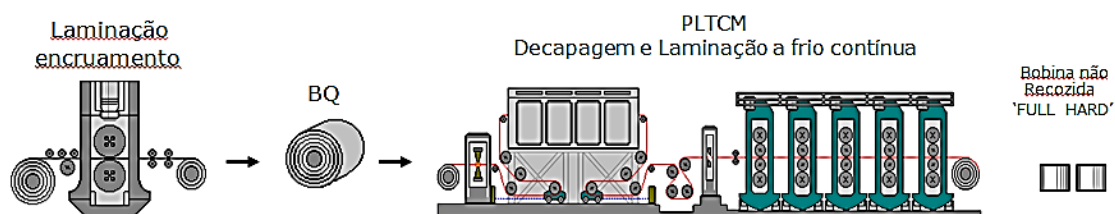
Figura 3.17: Fluxo do processo de laminação a frio. (Adaptado Usiminas, 2010).
