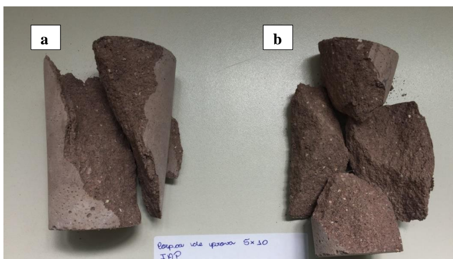
Figura 5-17: Corpos de prova 5x10 rompidos de metabásica flash
