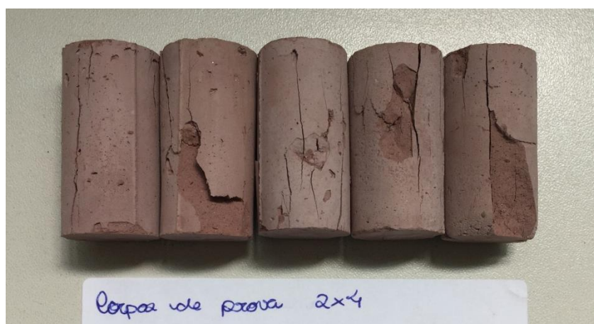
Figura 5-13: Corpos de prova 2x4 rompidos de metabásica flash e cal hidratada
