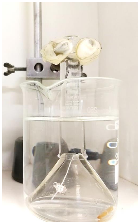
Figura 7.1 – Esquema da montagem utilizada para determinação da perda de massa por evolução de hidrogênio
