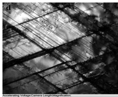
Figura 3. 8 - Micrografia obtida por meio do MET de um aço duplex após 10% de deformação [15].
