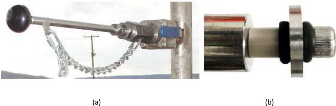
Figura 28. (a) Porta cupom instalado em tubulação de processo. (b) Detalhe de um cupom circular na haste
