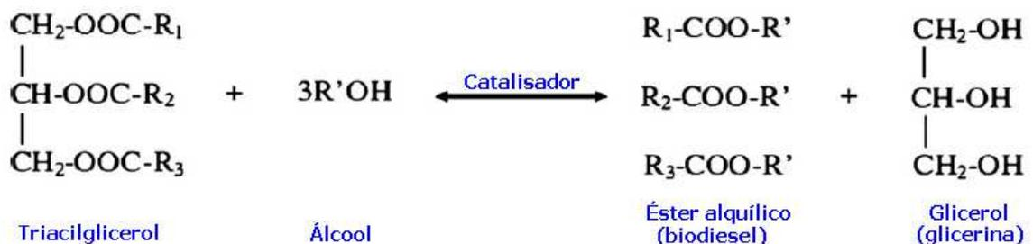
Figura 3. Representação da transesterificação de triglicerídeo com álcool
