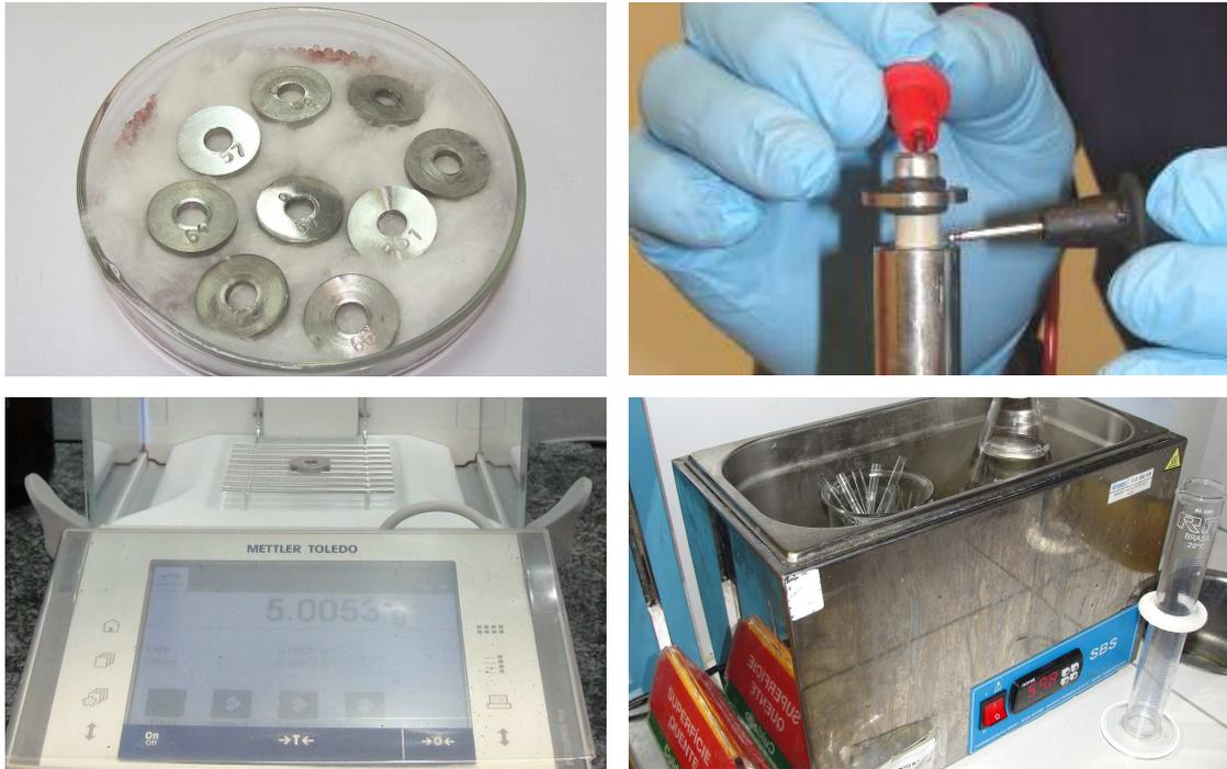
Figura 51. Ilustração de etapas do procedimento de monitoração da corrosão com cupons de perda de massa (Em sentido horário: armazenamento; teste de isolamento elétrico; remoção de óxidos; pesagem final)
