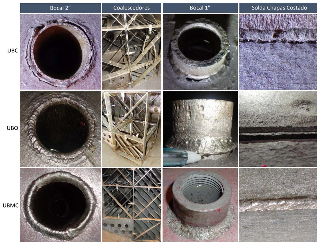
Figura 139. Comparativo entre Usinas do nível de degradação dos vasos decantadores V-2006
