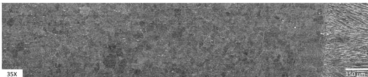
Figura 127. Perfil metalográfico da ZTA do aço AISI 904L
