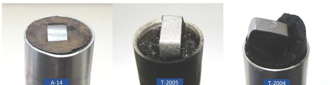
Figura 107. Sondas com diferentes níveis de degradação da resina epóxi que abriga o elemento sensor
