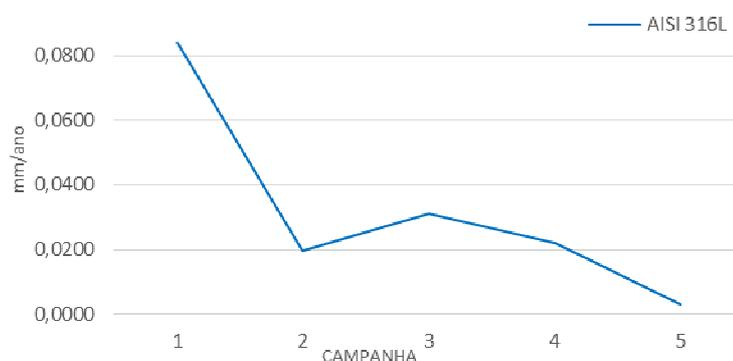
Figura 93. Gráfico com as taxas de corrosão (mm/ano) dos cupons instalados no ponto de monitoração 03
