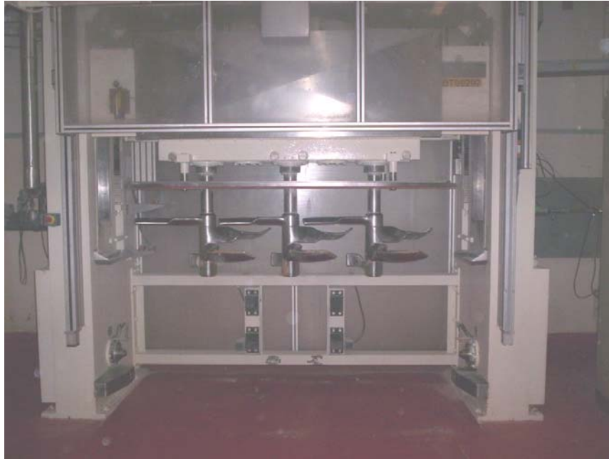
Figura 14: Misturador de haste vertical utilizado na produção de biscoito cream cracker .
