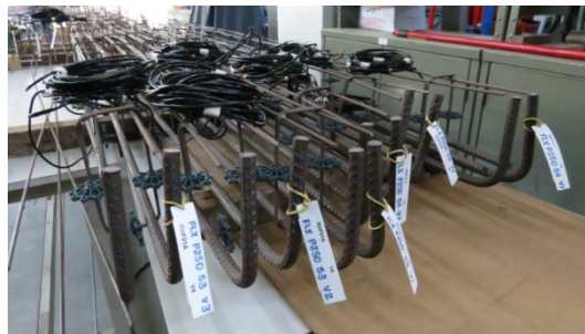
(e) etiquetas de identificação dos cabos
