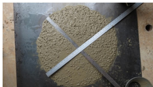
(d) ensaio do espalhamento
