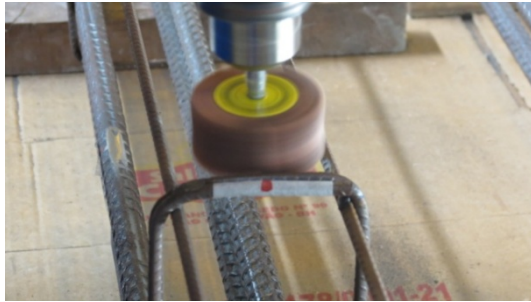
(a) preparação da superfície
