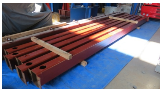
(c) empilhamento dos tubos de aço das vigas mistas sem laje colaborante
