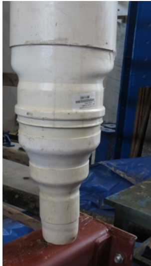
(a) detalhe das luvas de redução
