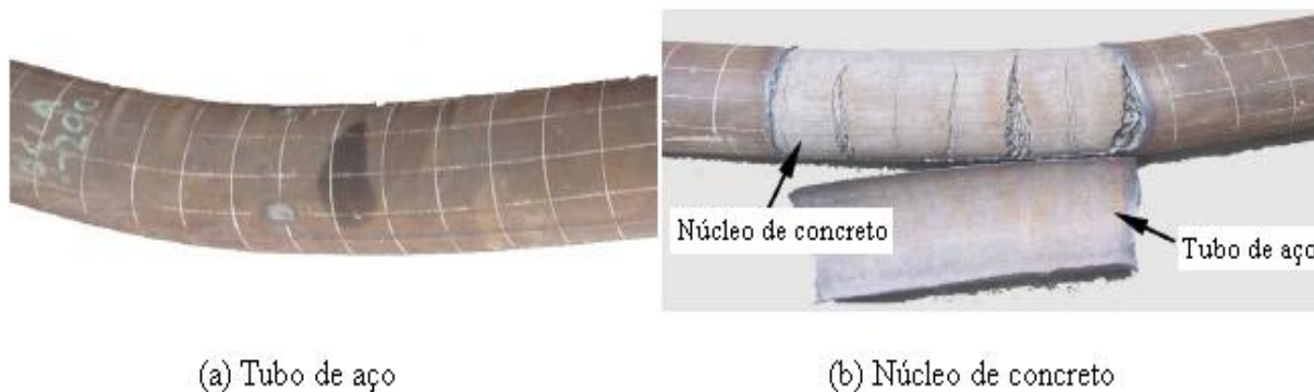
Figura 2.15 – Modo de falha típico dos protótipos circulares ensaiados por Han et al. (2006)
