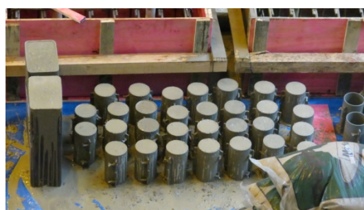
(b) término da moldagem do primeiro lote de cps
