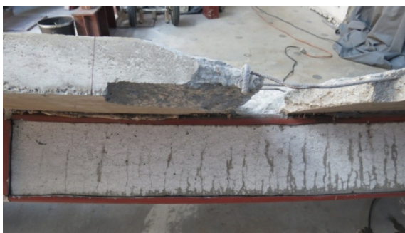
(c) região da carga concentrada a 2L/3
