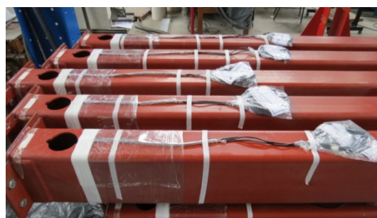
(b) proteção dos cabos dos extensômetros
