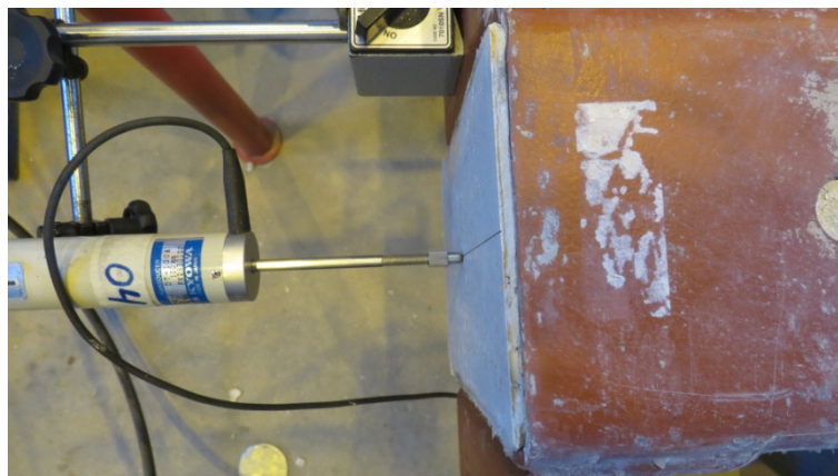
Figura 6.32 – Ensaio de flexão: escorregamento entre tubo de aço e núcleo de concreto
