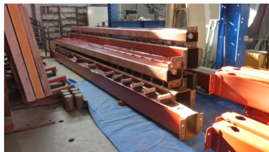
(b) empilhamento dos tubos de aço das vigas mistas com laje colaborante
