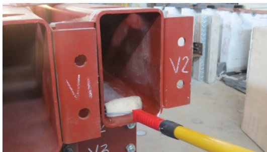
(a) lubrificação com rolo
