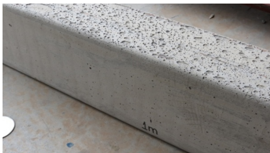
(a) concretagem sem pressão
