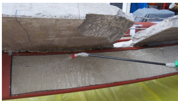
(c) aspersão de água em viga mista com laje colaborante
