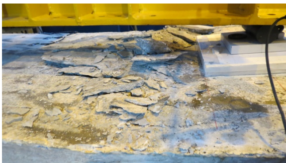
(c) deslocamento do concreto (vista anterior)
