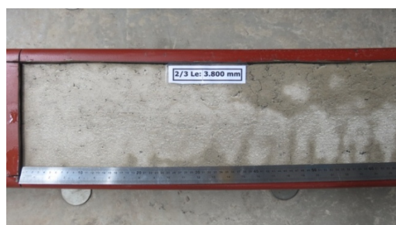
(c) região da carga concentrada a 2L/3
