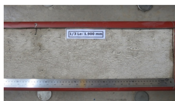
(b) região da carga concentrada a L/3
