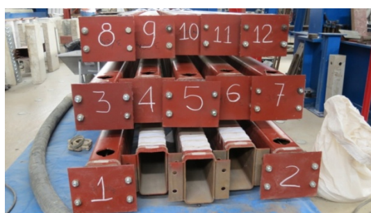
(a) ordem sequencial para a concretagem
