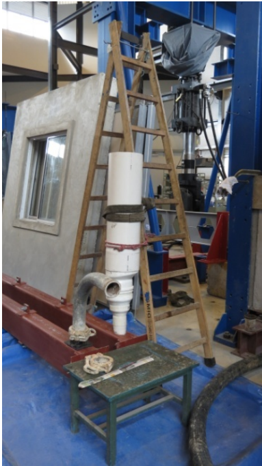
Figura 5.7 – Ensaios de concretagem: instalação dos dispositivos para lançamento do concreto
