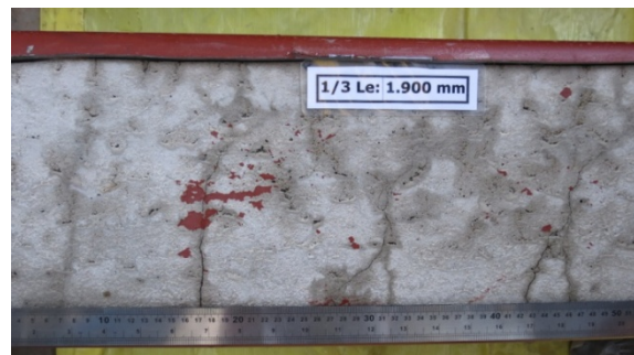
(b) região da carga concentrada a L/3
