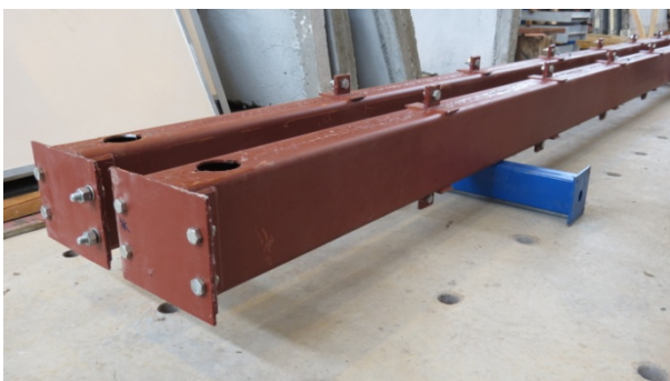
(e) sistema de fechamento das extremidades
