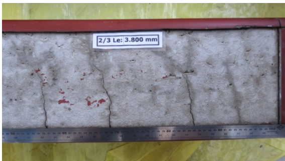
(c) região da carga concentrada a 2L/3
