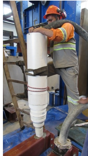
(b) injeção do concreto pelo funil
