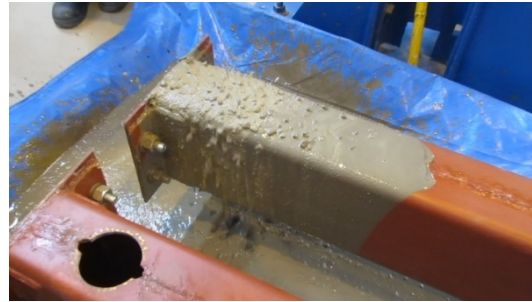
(a) concretagem sem pressão
