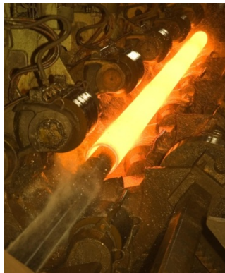
Figura 3.1 - Fabricação de perfis tubulares circulares Cortesia: Vallourec Tubos do Brasil S.A.
