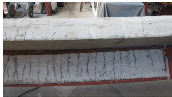
(b) região da carga concentrada a L/3
