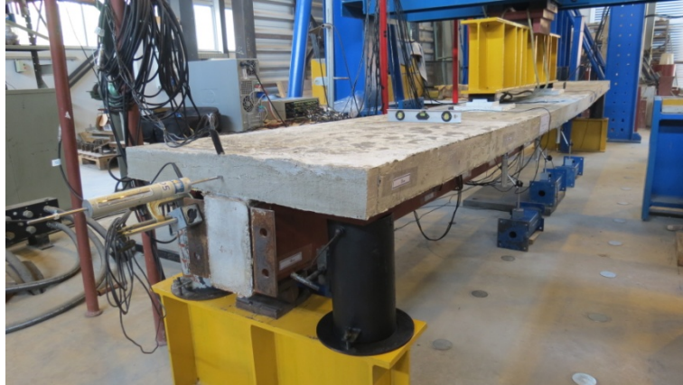
Figura 6.21 – Resultados experimentais: ensaio de flexão de viga mista com laje colaborante
