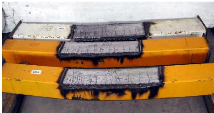
Figura 2.13 – Modo de falha típico do concreto nos protótipos ensaiados por Gho e Liu (2004)
