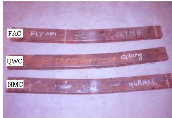
Figura 2.17 – Modo de falha típico dos protótipos ensaiados por Soundararajan e Shanmugasundaram (2008)
