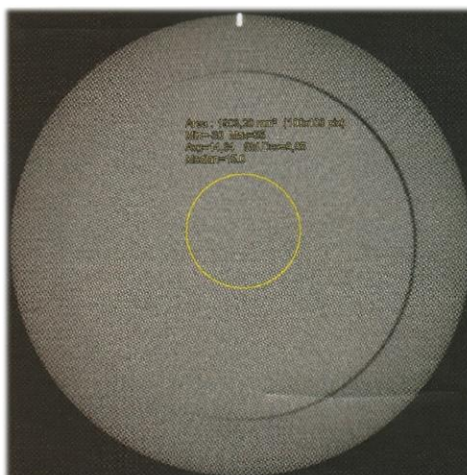
Figura 28: Imagem de simulador para a avaliação do ruído na imagem de TC.
