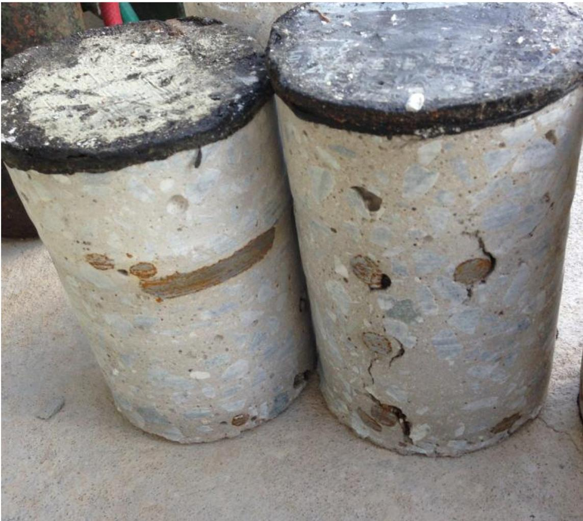
**Figura 3 - corpos de prova com barras interceptadas por furos em elementos concretagem**
