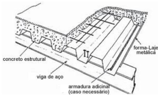
Figura 1-3 – Composição da laje mista
