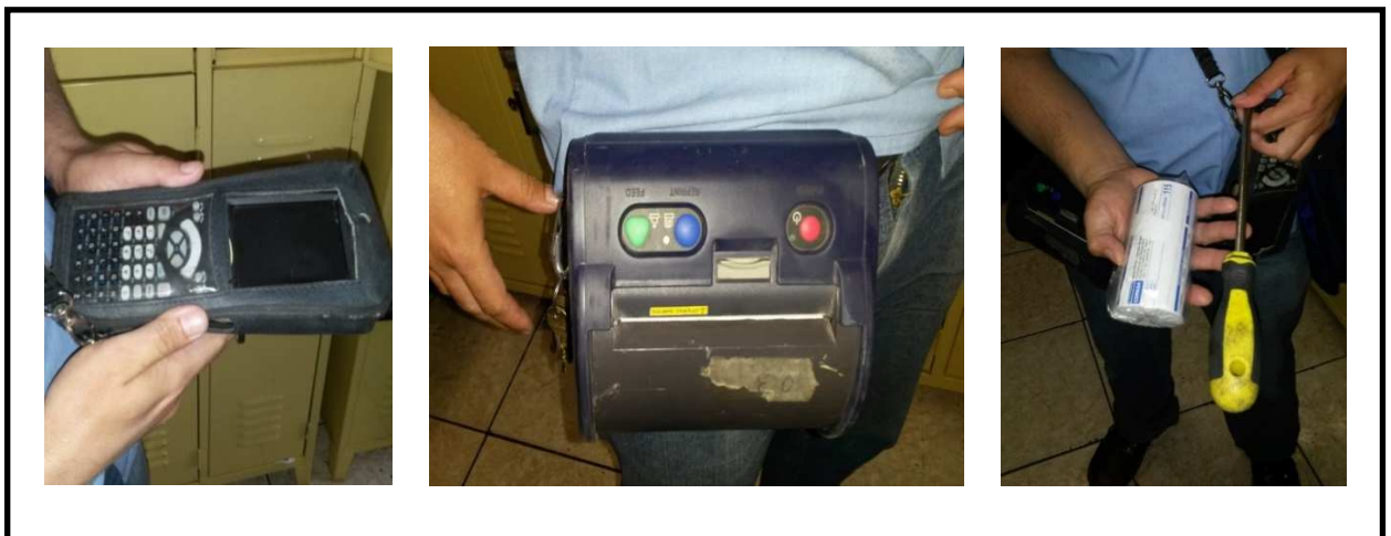
FIGURA 1- coletor de dados (peso 0,729kg); impressora (peso 1,206kg); bobina e chave de fenda
