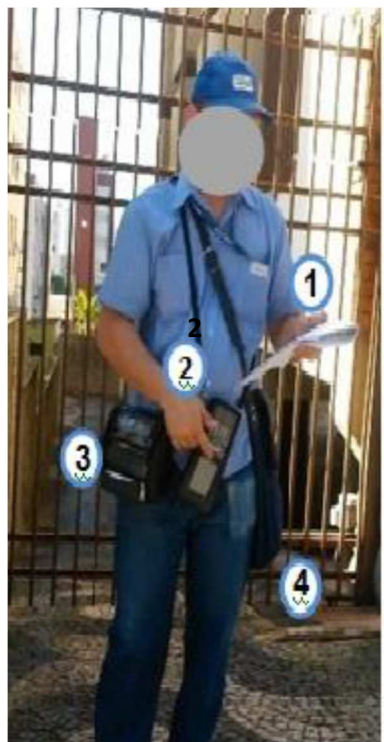
FIGURA 2 – disposição dos instrumentos e acessórios durante a atividade: 1- bl; 2- coletor de dados; 3- impressora portátil; 4- bolsa lateral (uso opcional).
