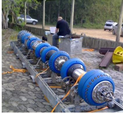
Figura 3: Pig instrumentado utilizado para inspeção de um mineroduto [9].
