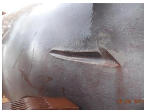
Figura 12: Arrancamento mecânico de material em tubulação de mineroduto [9].
