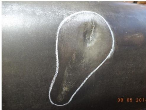
Figura 10: Exemplo de amassamento em tubulação de mineroduto [9].
