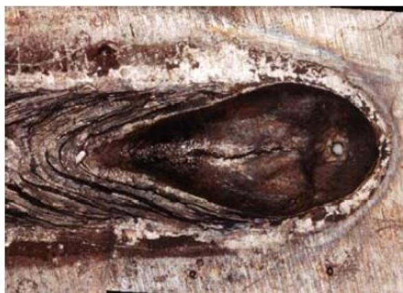
Figura 30: Perfuração de dutos durante a soldagem [26].
