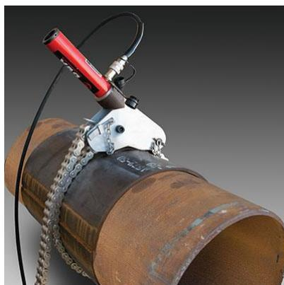
Figura 16: Dispositivo mecânico para comprimir a luva bipartida sobre o duto [17].
