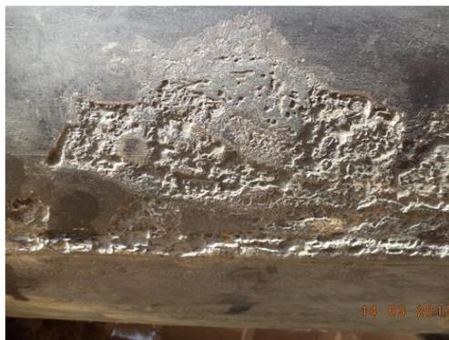
Figura 11: Corrosão externa em tubulação de mineroduto [9].
