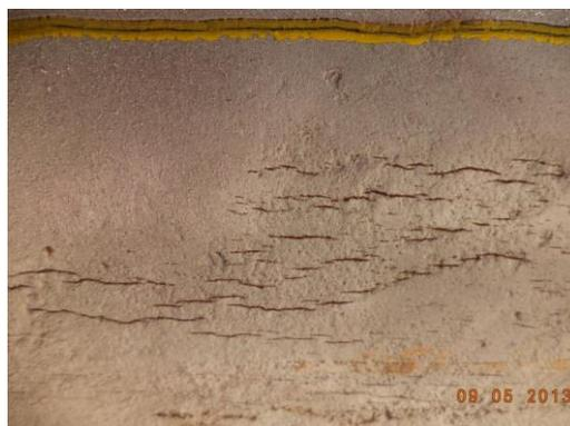
Figura 13: Trinca presente em tubulação de mineroduto [9].
