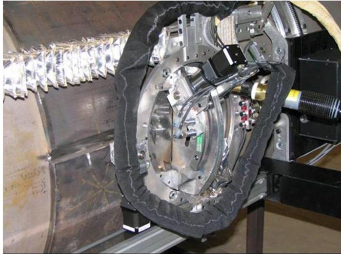
Figura 38: Sistema de posicionamento da tocha de soldagem [18].
