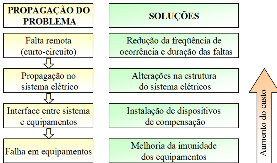
Figura 2.18: Propagação dos distúrbios momentâneos de tensão e soluções.
