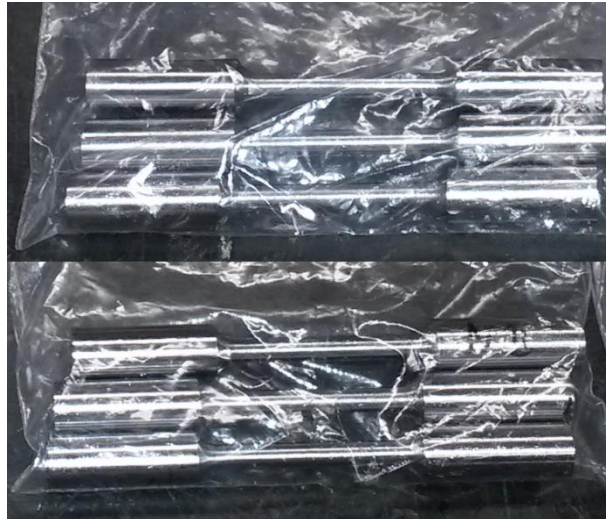
Figura 4.5 - Corpos de prova para ensaio de tração
