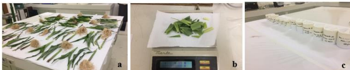
Figura 9. Amostras sendo: (a) secas; (b) pesadas; (c) acondicionadas em béquer de Teflon. Fonte: Silva, 2019.
