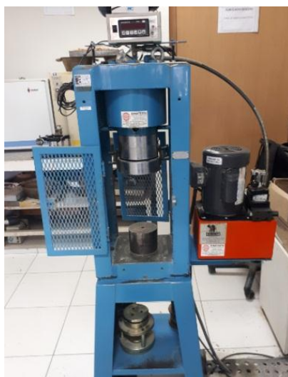
Figura 4.15 – Máquina de ensaios utilizada para ensaio de resistências mecânicas.
