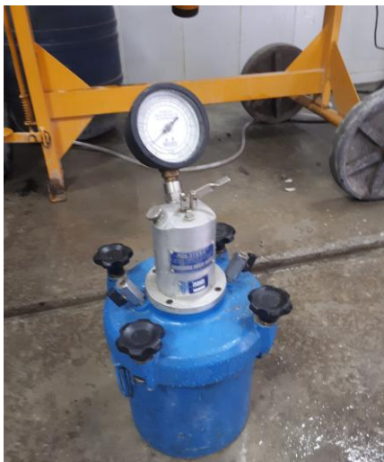
Figura 4.13 – Ensaio de teor de ar incorporado pelo método pressométrico nos dois tipos de concreto estudados: convencional e autoadensável.
