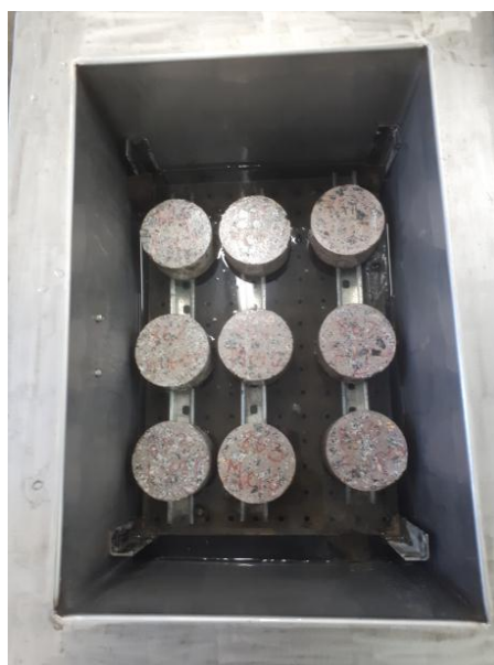
Figura 4.22 – Execução de ensaio de absorção de água por capilaridade.
