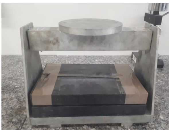
Figura 4.17 – Aparato para ensaio de resistência à tração por compressão diametral.
