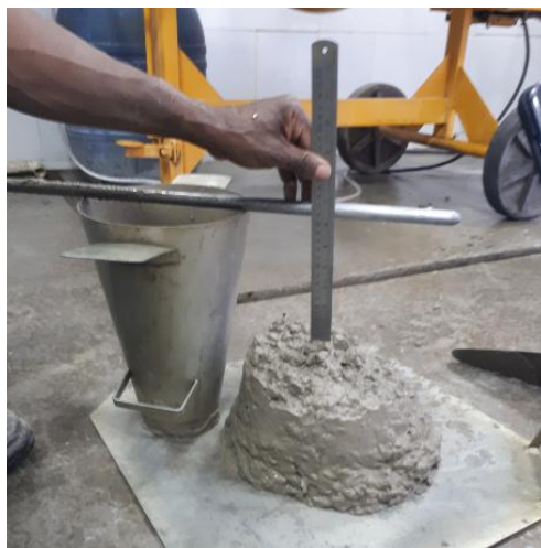
Figura 4.11 – Ensaio de abatimento do tronco de cone (slump test) no concreto convencional.
