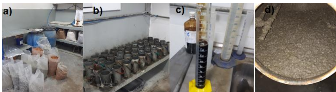
Figura 4.10 – Imagens de etapas do processo de preparo dos concretos: a) separação dos materiais; b) preparação dos CP's; c) aditivo MIRA 481; d) mistura.
