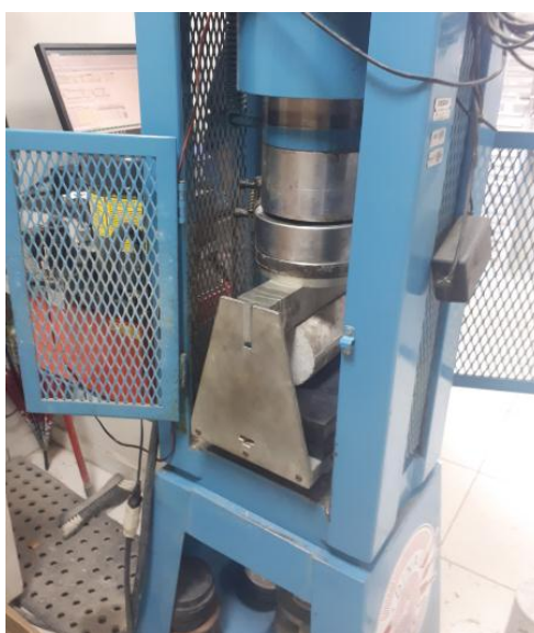
Figura 4.18 – Ensaio de resistência à tração por compressão diametral.
