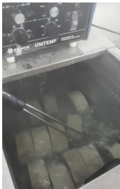
Figura 4.23 – Etapa de fervura dos corpos de prova para o ensaio de imersão.
