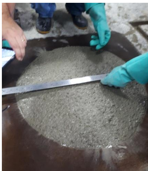
Figura 4.12 – Ensaio de determinação do espalhamento (slump flow test) no concreto autoadensável.
