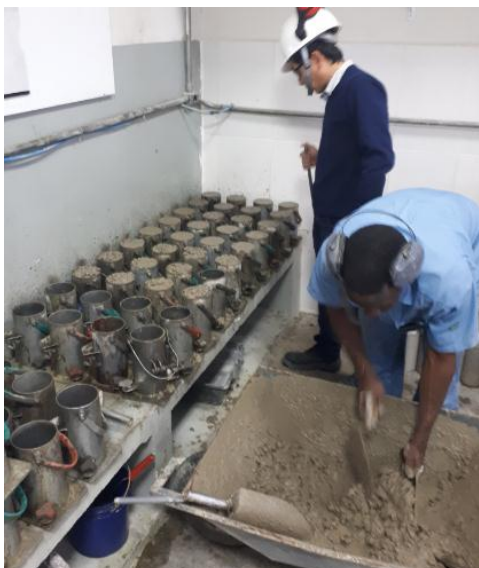
Figura 4.14 – Moldagem dos corpos de prova de concreto.
