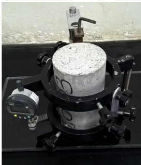
Figura 4.19 – Compressômetro de bases dependentes utilizado no ensaio de módulo de elasticidade.
