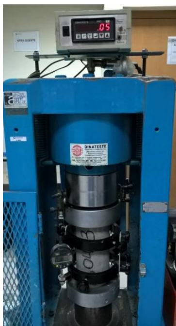
Figura 4.20 – Execução de ensaio de módulo de elasticidade.
