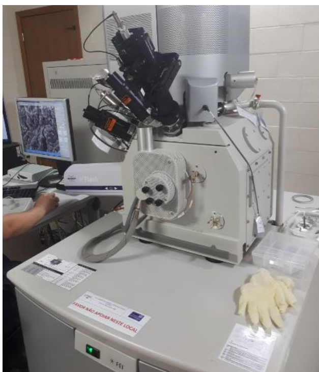
Figura 4.24 – MEV modelo FEG - Quanta 200 FEI do Centro de Microscopia da UFMG.
