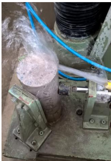
Figura 4.16 – Realização de retificação de corpo de prova de concreto.
