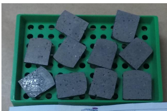
Figura 3.28 – Amostras preparadas para ensaios MEV
