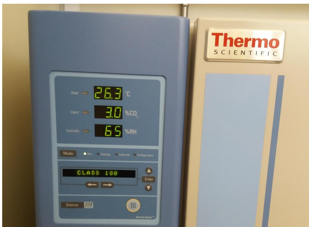
Figura 3.23 - Condições de exposição dos corpos de prova no interior da câmara de carbonatação
