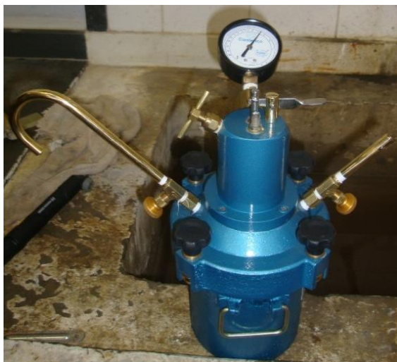
Figura 3.16 - Medidor de ar incorporado à argamassa
