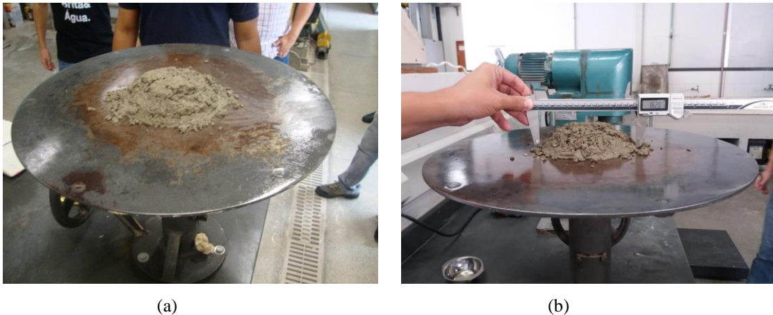
Figura 3.15 - (a) Massa após o espalhamento e (b) medição do diâmetro da massa espalhada
