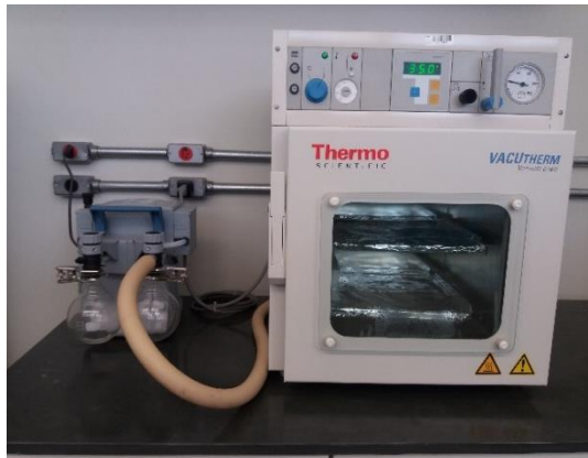
Figura 3.17 - Estufa a vácuo utilizada nos ensaios
