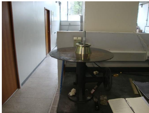
Figura 3.13 - Aparelho utilizado para determinação da consistência da argamassa normal
