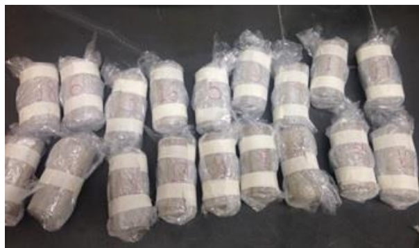
Figura 3.18 - CPs envoltos em filme de PVC
