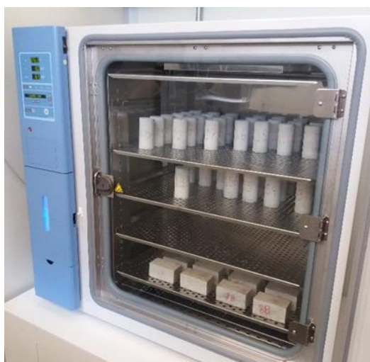
Figura 4.5 - Corpos de prova no interior da câmara
