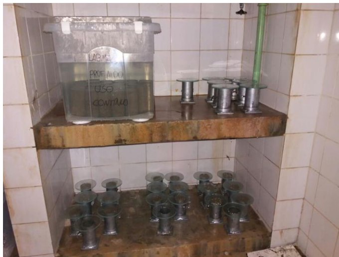
Figura 3.12 - Corpos de prova após moldagem, na câmara úmida
