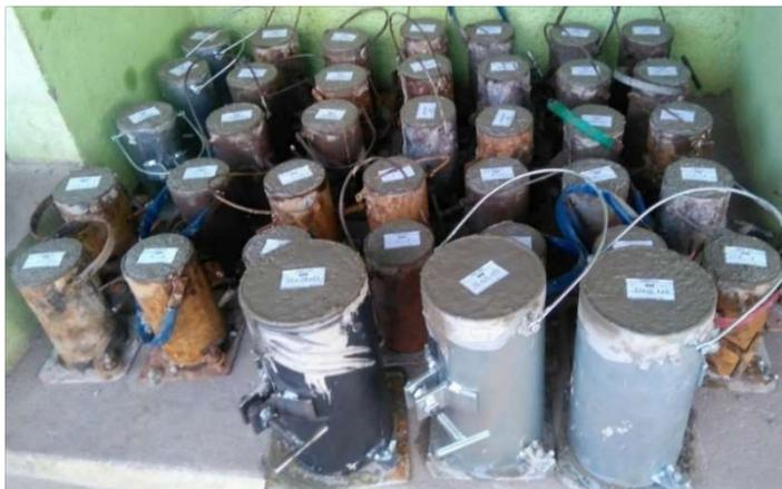
Figura 3.9 - Moldagem dos CPs
