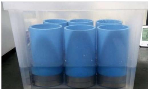
Figura 3.22 - Teste de estanqueidade do conjunto
