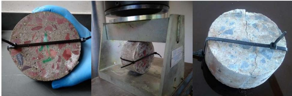
Figura 3.25 - Amostras antes (I), durante (II) e depois (III) do seccionamento diametral
