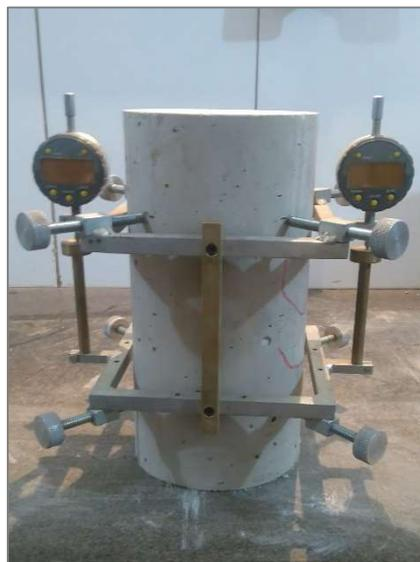
Figura 3.13 - CP no compressômetro
