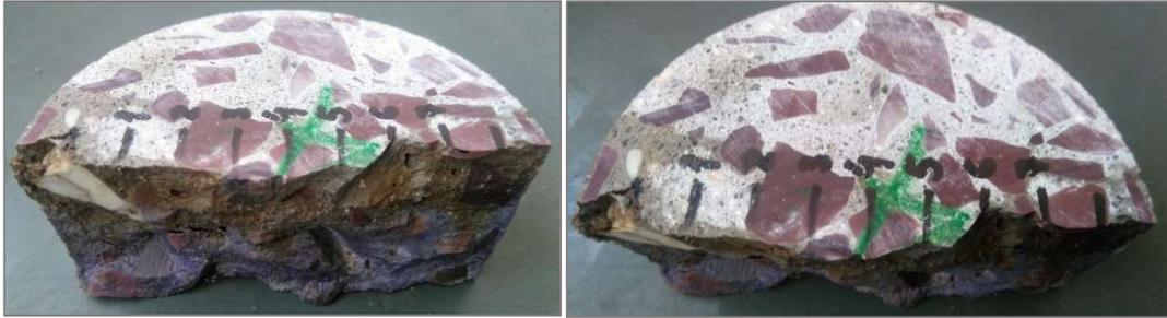
Figuras 3.27 - Marcações para medição das profundidades de penetração dos íons cloreto
