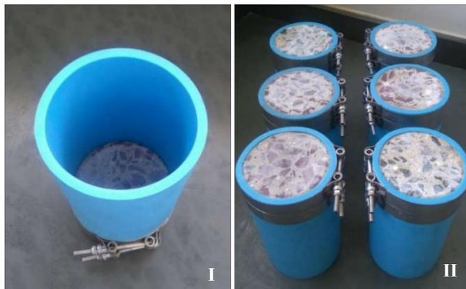
Figuras 3.17 - Montagem das amostras nas camisas de silicone
