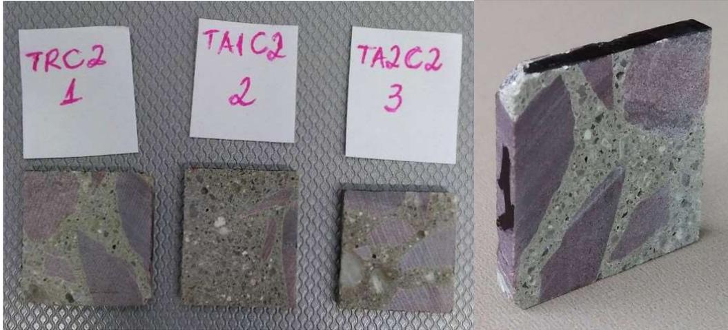
Figura 3.29 - Amostras cortadas e retificadas para ensaio do MEV e detalhe da amostra
