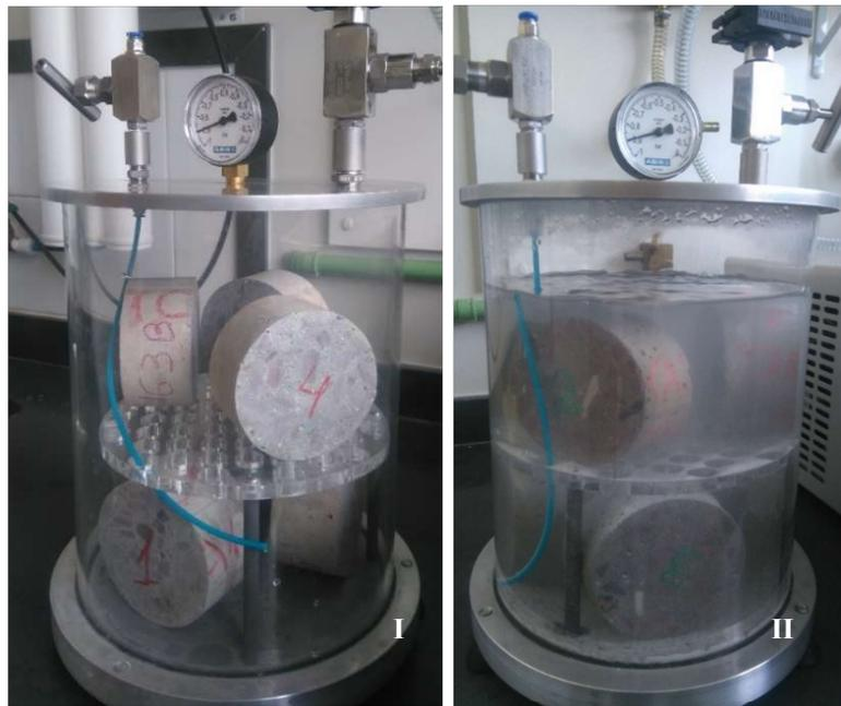
Figuras 3.19 - Amostras na câmara de vácuo
