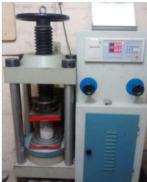
Figura 3.11 - Prensa utilizada para ensaios mecânicos
