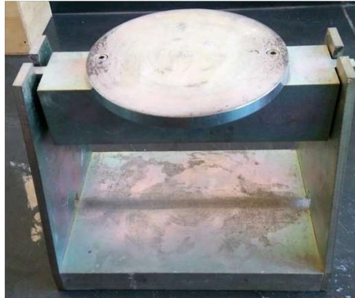
Figura 3.12 - Aparato utilizado para ensaio de tração
