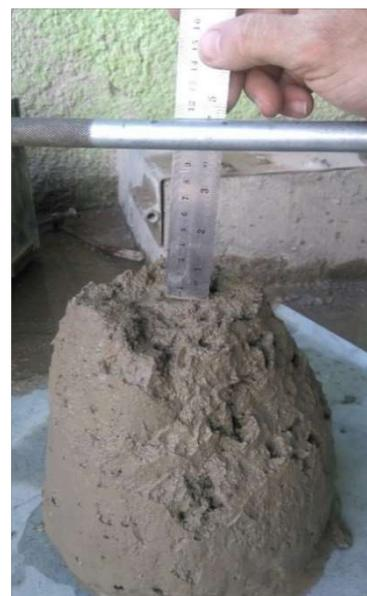
Figura 3.8 - *Slump Test*
