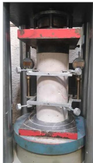
Figura 3.14 - Conjunto posicionado na prensa
