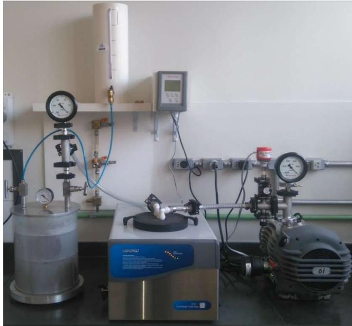
Figura 3.20 - Conjunto de vácuo: câmara de vácuo, ColdTrap e bomba de vácuo
