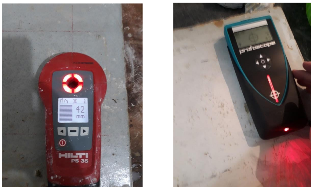
Figura 37 – Aferição das camadas de cobrimento executadas
