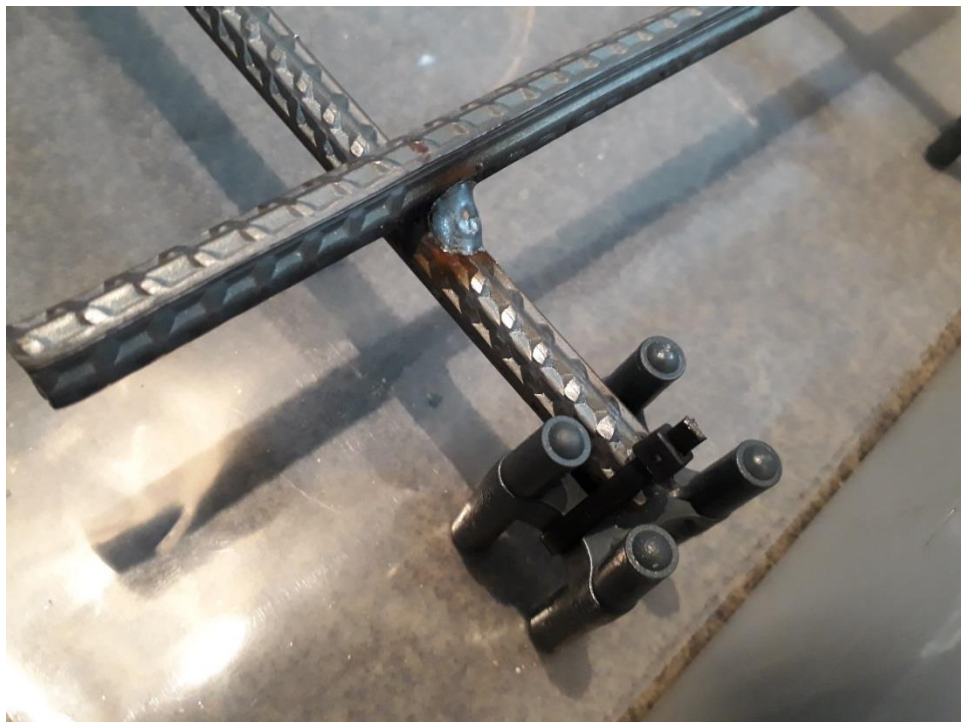
Figura 34 – Detalhe do espaçador e do plástico utilizado na moldagem dos corpos de prova
