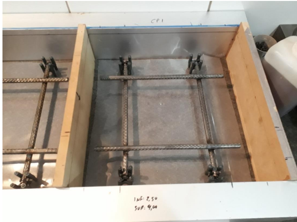
Figura 33 – Imagem aproximada do gabarito para moldagem dos corpos de prova
