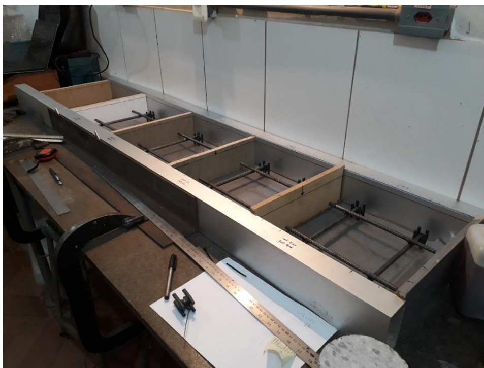
Figura 32 – Gabarito para moldagem dos corpos de prova
