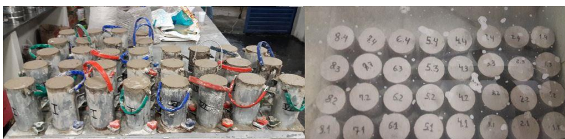
Figura 21 - Moldagem e cura dos corpos de prova
