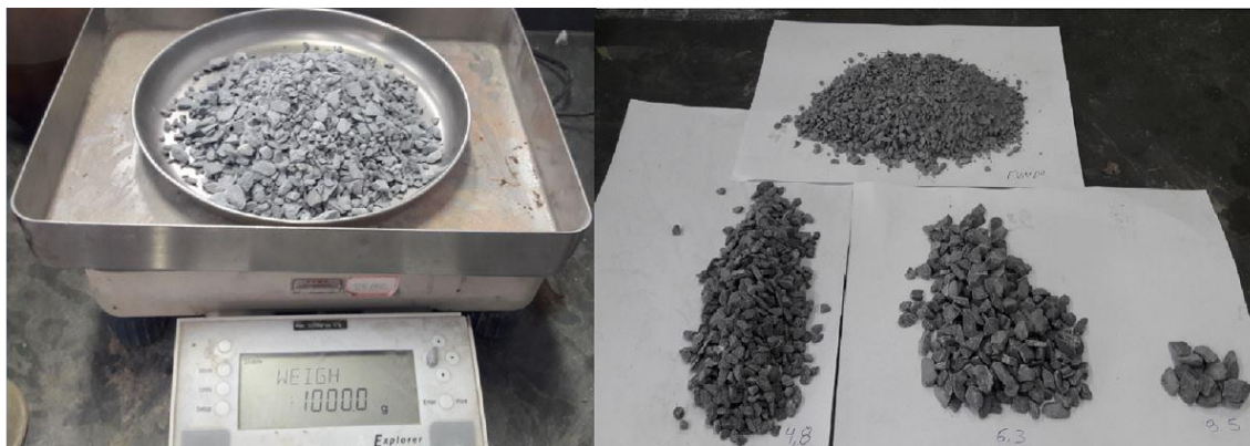
Figura 6 - Amostras do agregado graúdo (brita "0") utilizadas no ensaio de granulometria.
