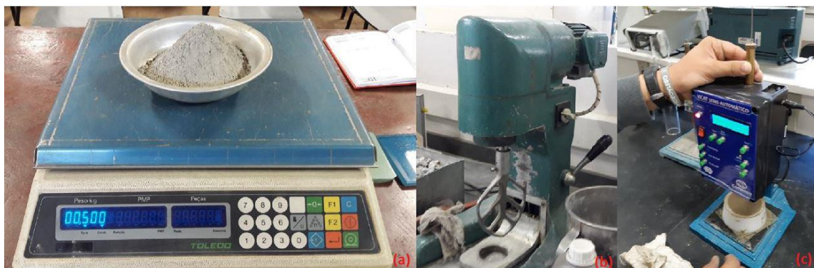
Figura 13 - Ensaio de consistência normal da pasta de cimento
