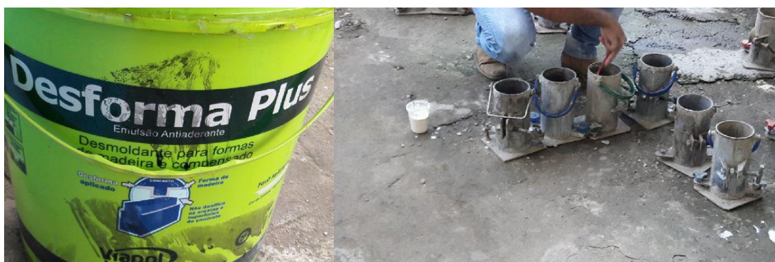
Figura 20 - Aplicação de desmoldante em moldes cilíndricos
