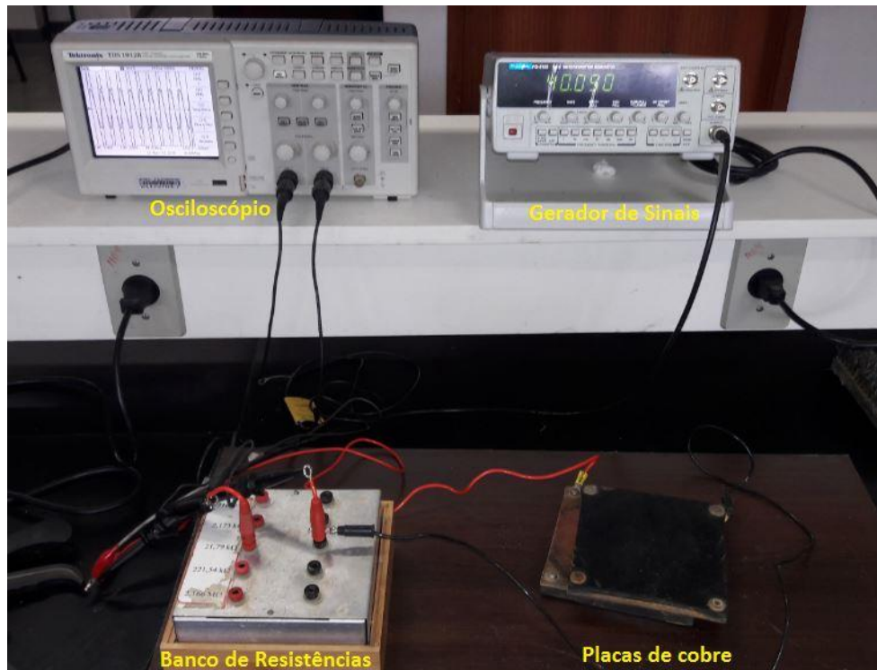
Figura 24 - Equipamento para medição da resistividade volumétrica da UFMG
