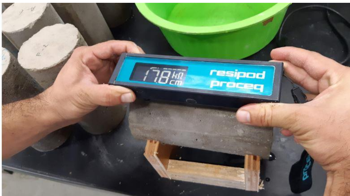
Figura 26 - Ensaio de resistividade elétrica superficial em corpos de prova.
