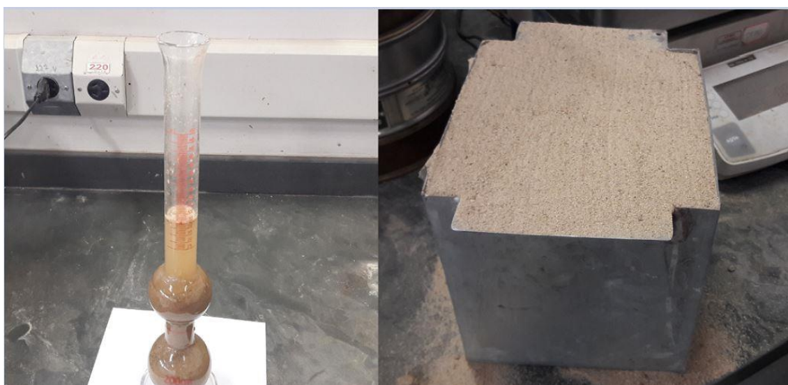
Figura 4 - Ensaio de massa unitária e massa específica do agregado miúdo.
