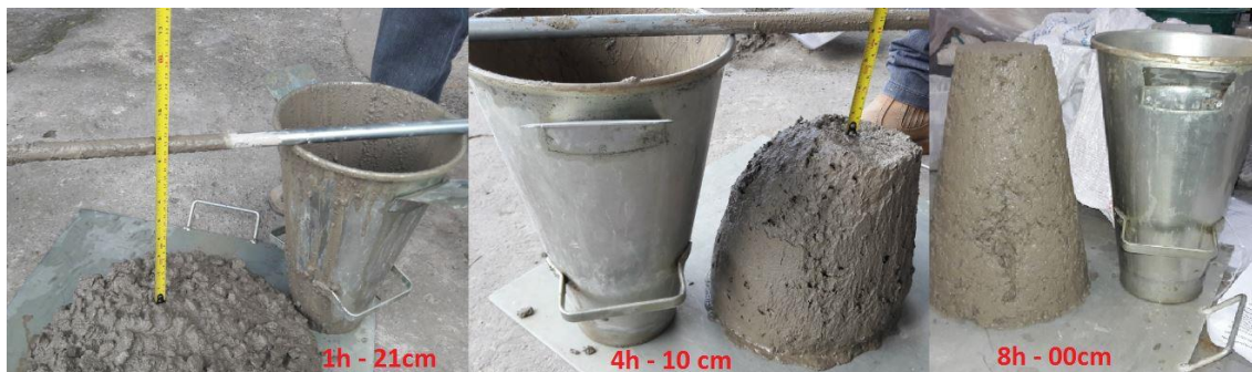
Figura 16 - Perda de abatimento durante o tempo de mistura da dosagem CP25-II
