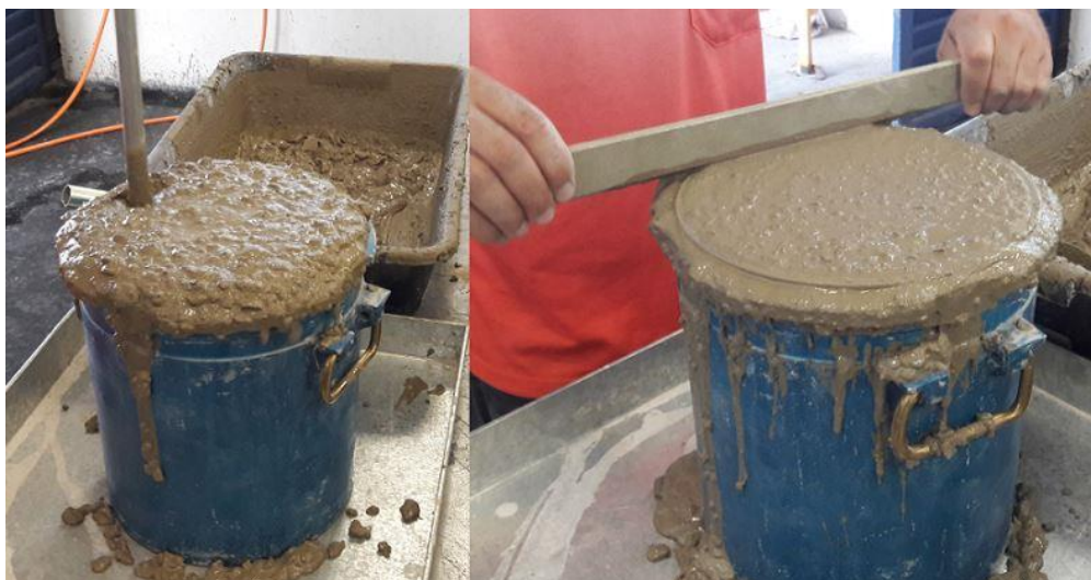
Figura 18 - Preparação da amostra para ensaio de massa específica do concreto fresco
