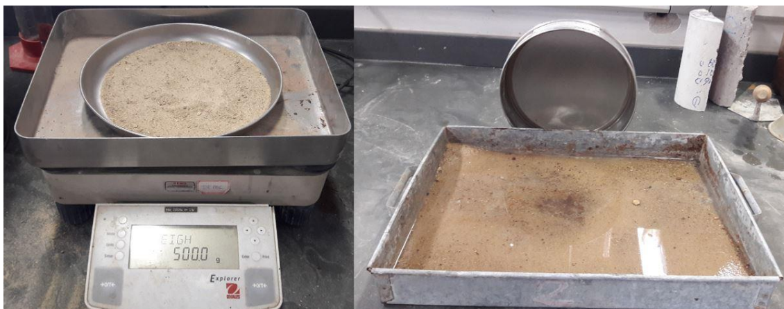
Figura 5 - Ensaio de determinação de material pulverulento do agregado miúdo.
