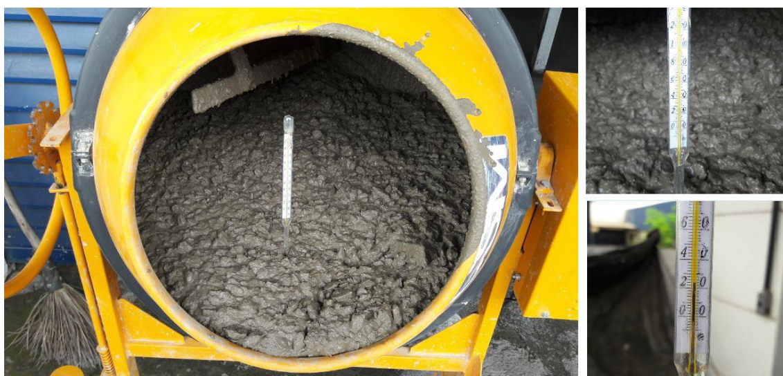
Figura 17 - Monitoramento da temperatura do concreto fresco durante a mistura
