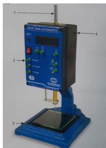
Figura 12 - Aparelho de Vicat semiautomático Fonte: Contenco (2018)
