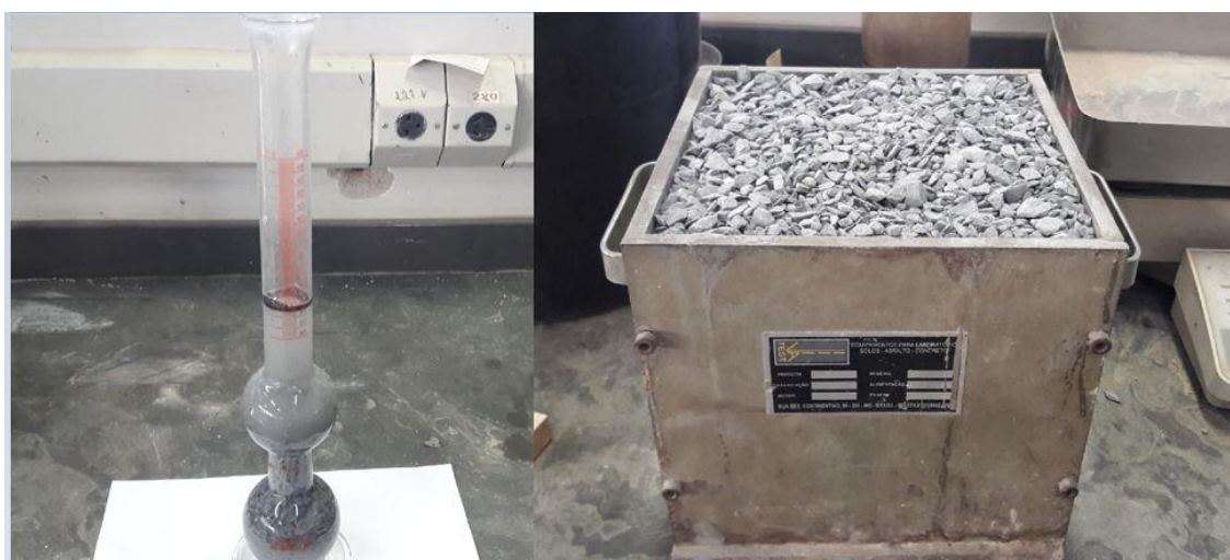
Figura 8 - Ensaios de massa unitária e massa específica do agregado graúdo (brita "0").
