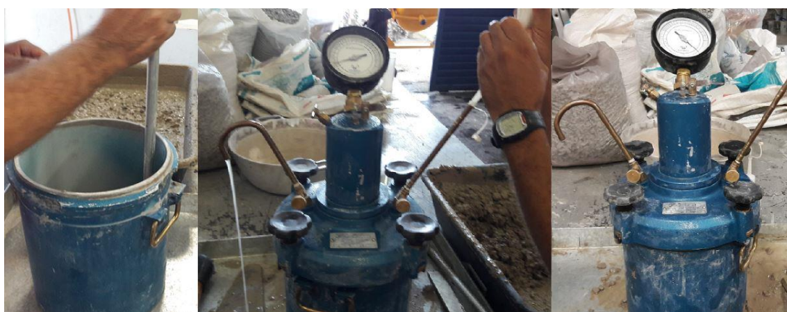
Figura 19 - Procedimentos de ensaio de teor de ar incorporado (pressométrico)
