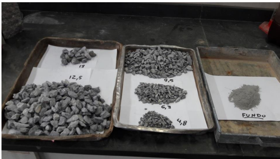
Figura 9 - Amostras do agregado graúdo (brita "1") retidas nas peneiras durante o ensaio de granulometria.
