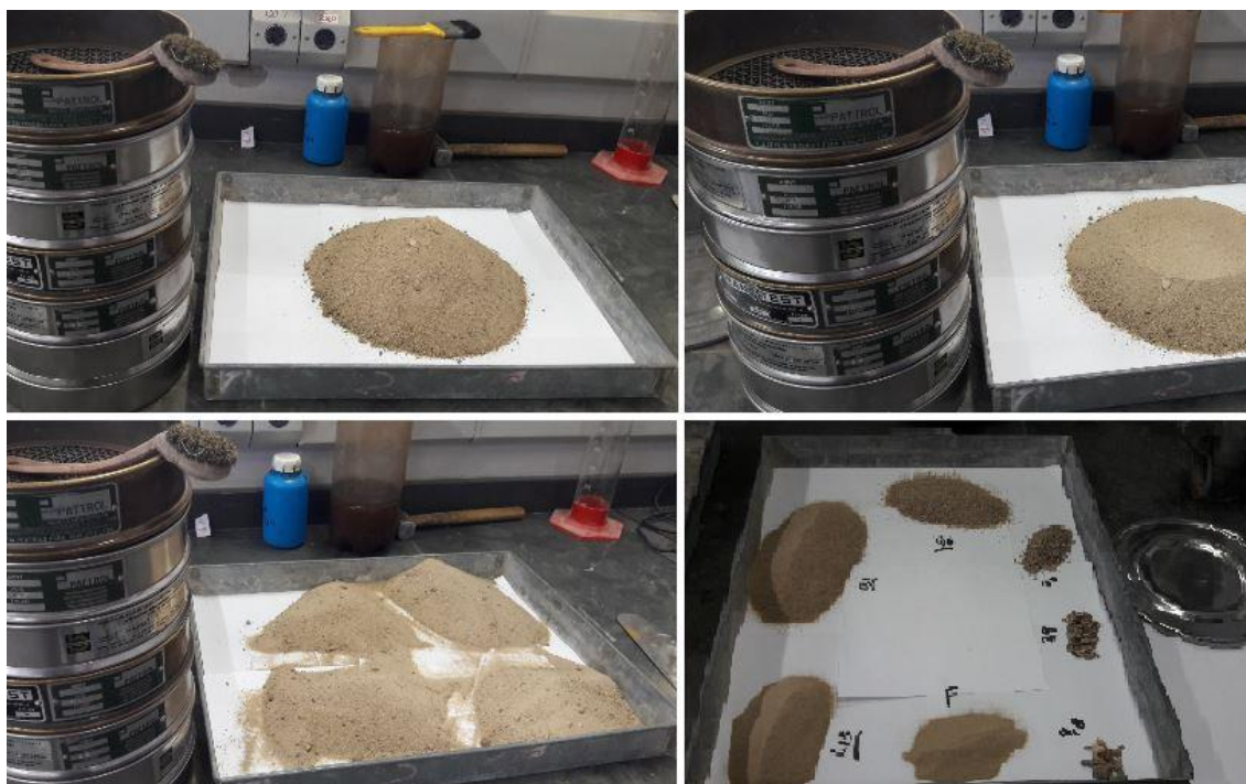
Figura 2 – Amostras do agregado miúdo (areia natural média) retidas nas peneiras durante o ensaio de granulometria.
