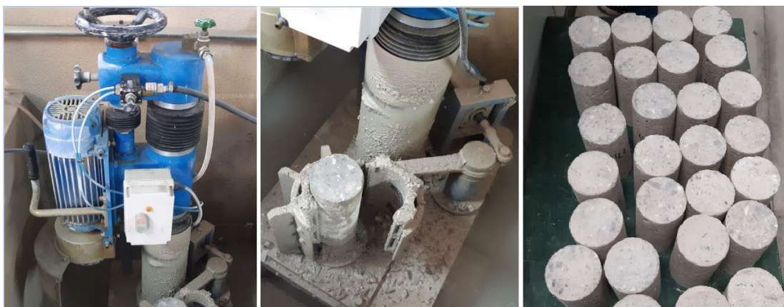
Figura 22 - Retífica dos corpos de prova na idade de 7 dias.
