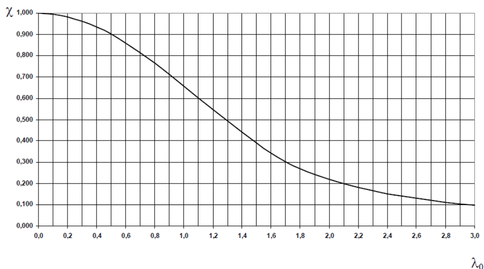
Figura 5.1- Curva de dimensionamento adotada pelas normas ABNT NBR 8800:2008 e ANSI/AISC 360-16. (Fonte: ABNT NBR 8800:2008).
