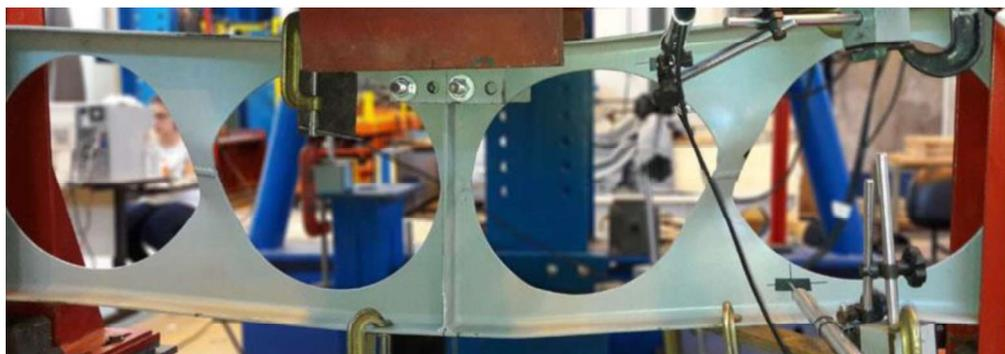
Figura 1.6 – Flambagem do montante de alma por cisalhamento (GRILO, 2018; GRILO *et al.*, 2018)
