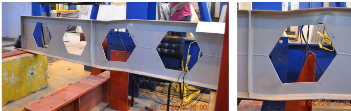
Figura 1.5 – Ensaio com deformações típicas do mecanismo Vierendeel (VIEIRA, 2015)
