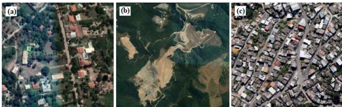
Figura 31: Exemplos de erros de atribuição utilizando-se o método de classificação supervisionada: (a) LCZ 9, classificada como LCZ B; (b) LCZ E, classificada como LZC 1; e (c) LCZ 3, classificada como LCZ 1.
