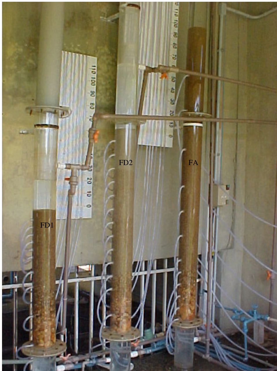
Figura 4.9: Vista dos filtros-piloto
