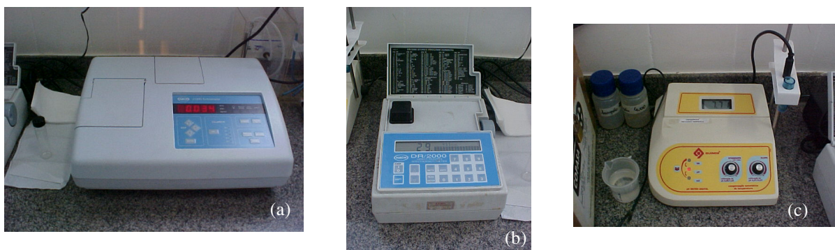
Figura 4.16: Equipamentos utilizados para determinar os parâmetros físico-químicos: (a) turbidez; (b) cor aparente; e (c) pH.
