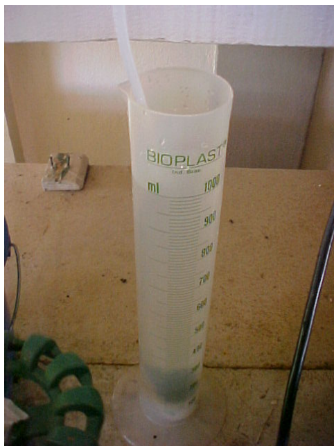
Figura 4.15: Aferição volumétrica da vazão de aplicação do coagulante
