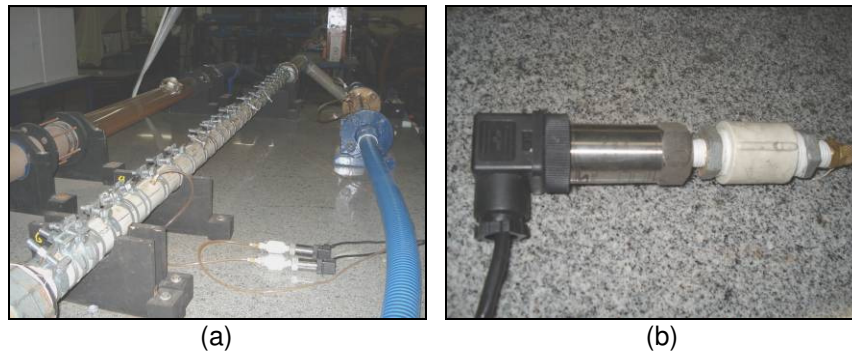
Figura 4.4: Detalhe da tomada de pressão. (a) Conexão dos piezômetros e transmissores no trecho de testes. (b) Detalhe do transmissor eletrônico de pressão.
