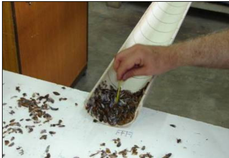
Figura 4.6: Detalhe da colagem de Limnoperna fortunei na calha da tubulação de testes.
