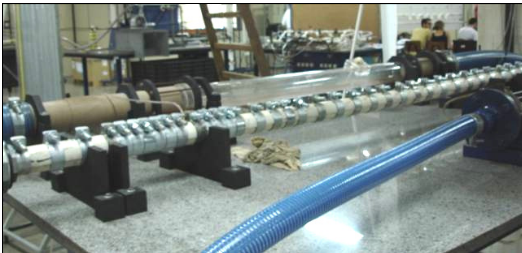
Figura 4.2: Vista geral da bancada de testes preparada para início dos testes de perda de carga em condutos infestados pelo Limnoperna fortunei .
