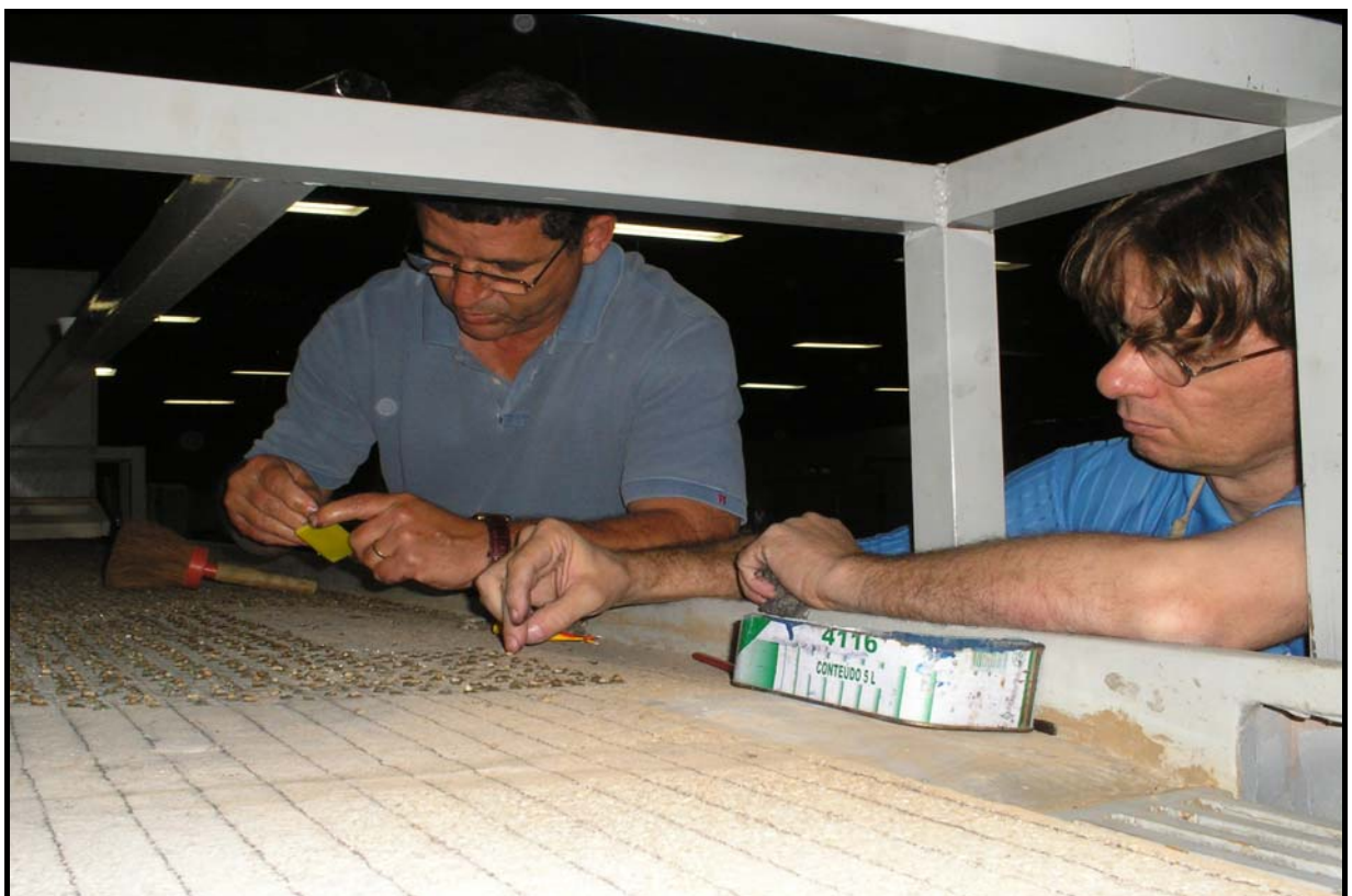
Figura 5.10 – Execução do revestimento final da superfície do modelo
