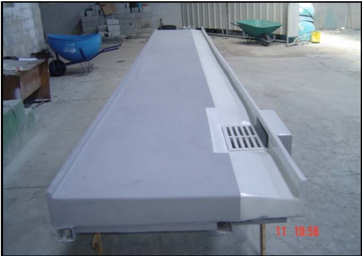
Figura 5.3 – Revestimento e pintura iniciais do modelo
