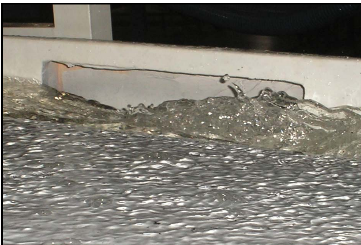
Figura 5.6 – Aspectos do escoamento no modelo antes das adaptações
