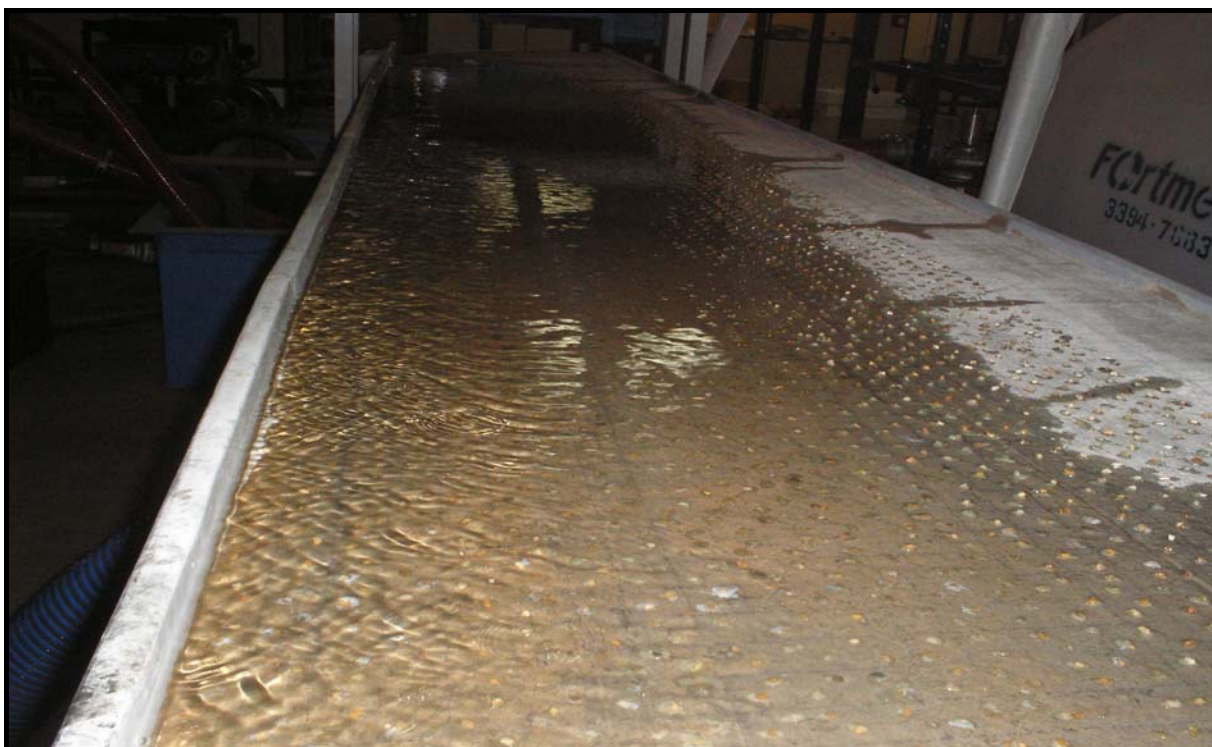
Figura 5.11 – Aspectos do revestimento final da superfície do modelo
