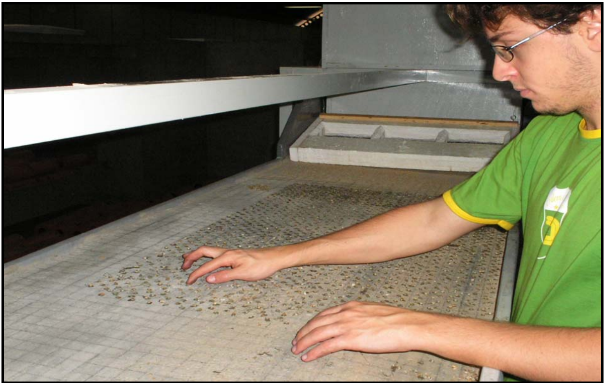
Figura 5.9 – Execução do revestimento final da superfície do modelo
