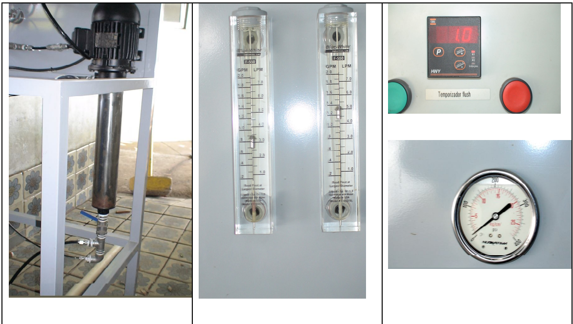
Figura 4-7: Conjunto moto-bomba, rotâmetros, temporizador e manômetro.
