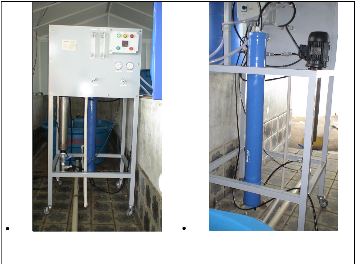
Figura 4-6: Vistas do conjunto-piloto de filtração em membranas da UFMG.
