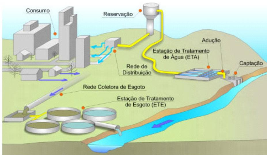
**Figura 4-1– Sistema de abastecimento e esgotamento urbano (Fonte: RHAMA, 2008).**
