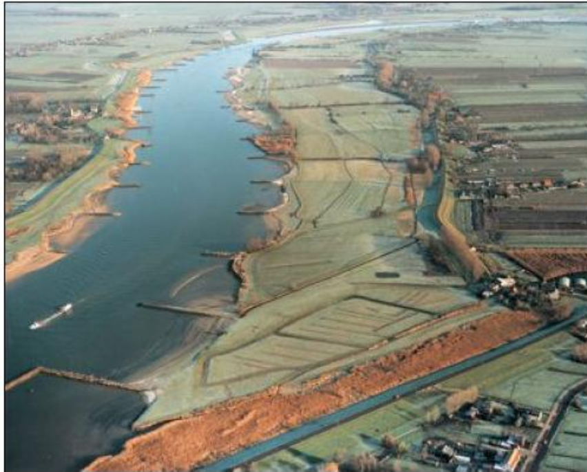
Figura 3.21: Espigões no rio Lek, Holanda Fonte: Geological Survey of Ireland (2008 apud Pereira, 2008)
