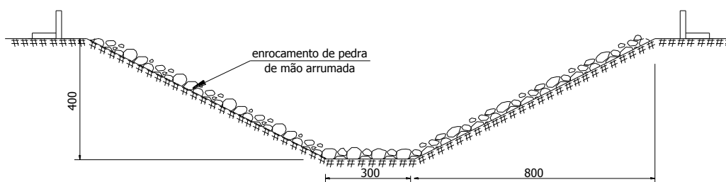
Figura I.5: Canal em enrocamento (medidas em cm) Fonte: Belo Horizonte (1994 apud Moura, 2004)
