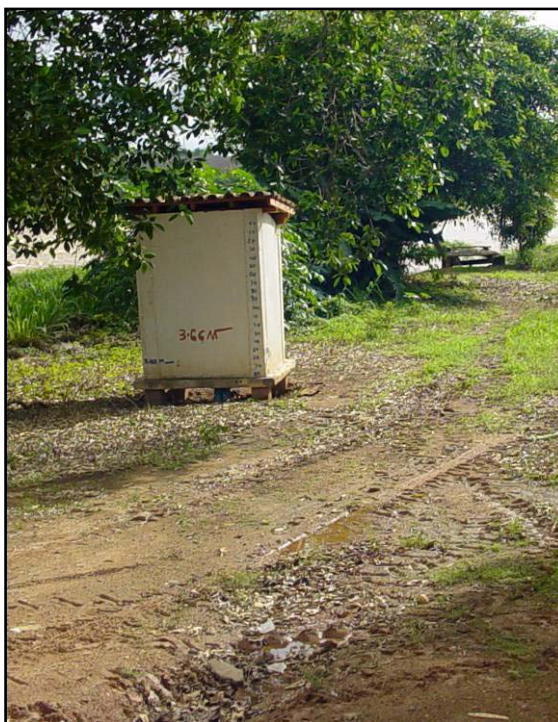
Figura 6.6 –Régua instalada na Univale (Parte jusante dos modelos).
