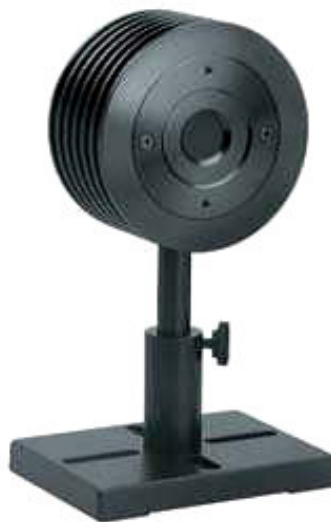
Figura 4.5 – Medidor de potência modelo Ophir 30A, faixa de medição de 20 mW a 30 W e tempo de resposta de 0,8 s (95%).
