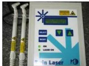
FIGURA 13 - Equipamento Laser MMóptics com as duas ponteiros de  $\lambda=680 \text{ nm}$  e  $\lambda=780 \text{ nm}$
