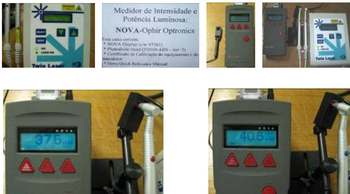
FIGURA 31 - Conjunto de fotografias mostrando o ensaio realizado para conferir estabilidade de emissão do laser medido com Powermeter.
