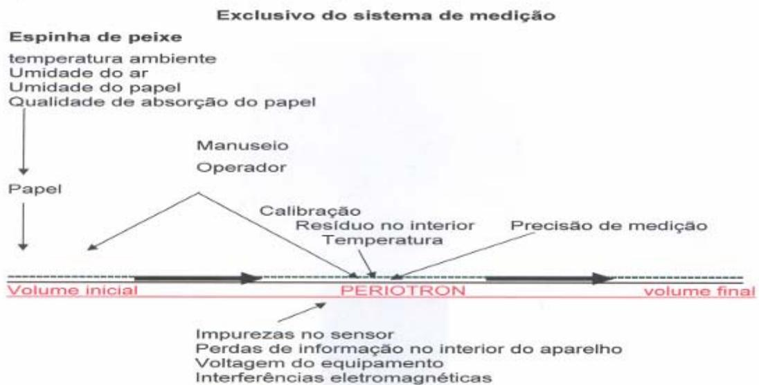
FIGURA 32 - Indicativos de incerteza do sistema de medição PERIOTRON esquematizado sobre o desenho espinha de peixe, modificado de BUCHMANN& SARKIS(2002).
