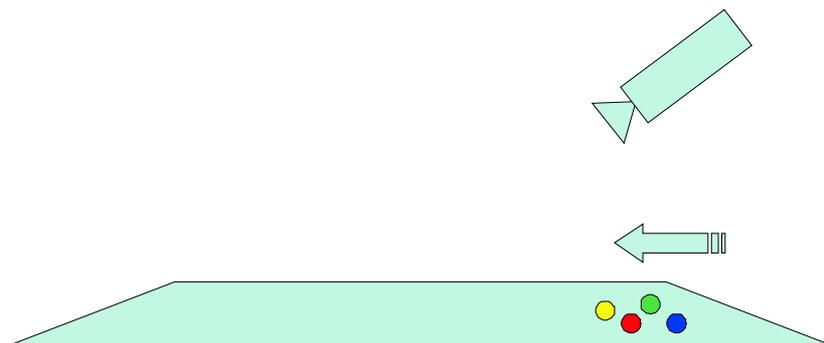
Figura 4.2: Esquemático do primeiro experimento. Uma câmera instalada no teto, adquire imagens de bolas coloridas que rolam no piso do laboratório.
