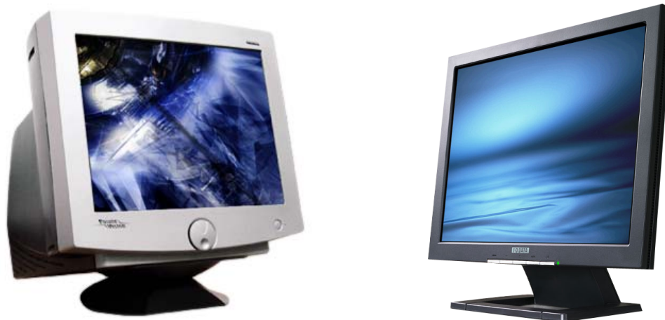
Figura 2.6: Tecnologias de monitores: CRT e LCD.
