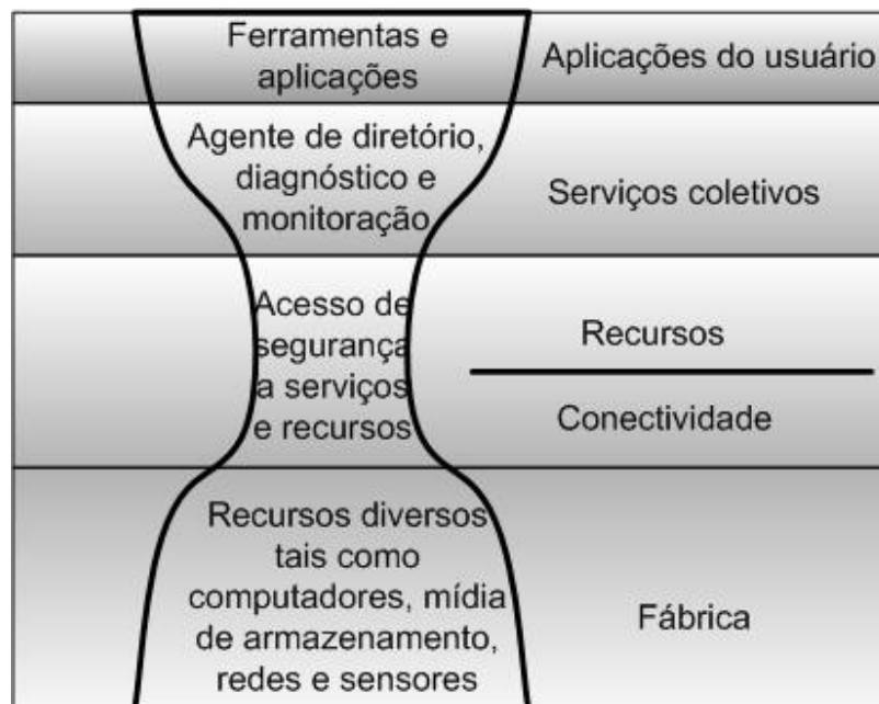
Figura 2-1: Arquitetura de grade computacional Fonte: [Foster & Kesselman 2004]
