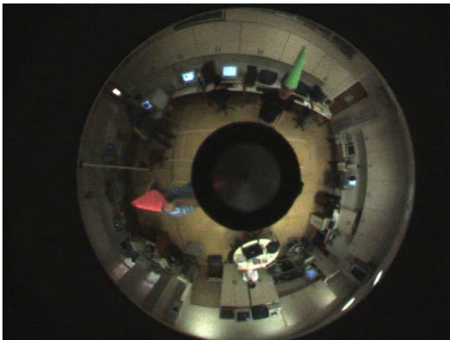
Figura 1.1: Exemplo de imagem obtida por uma câmera catadióptrica, note que as quatro paredes que formam o laboratório são capturadas.
