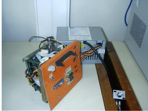
Figura 5.2: Computador de bordo, módulo *PC/104*, utilizado no Projeto *SiDeVAAN* (UFMG).
