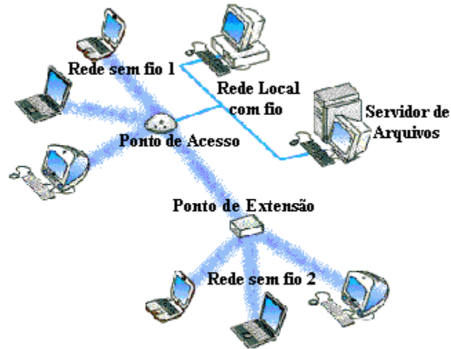
Figura 2.9: Rede sem fio com múltiplos PA e com ponto de extensão.
