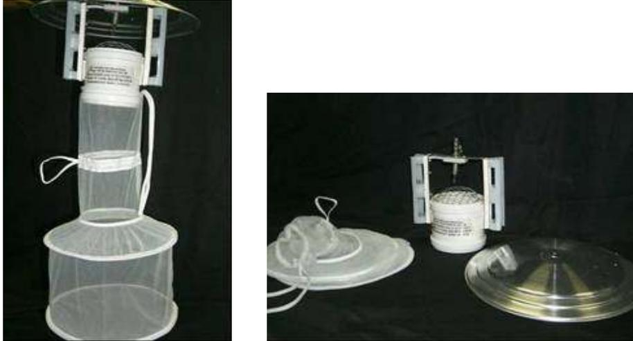
**Figura 2:** Armadilha luminosa CDC modificada (modelo HP) (Pugedo *et al.*, 2005).
