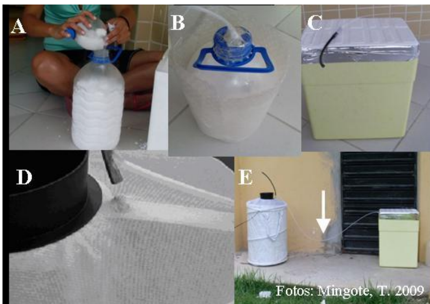
Fig 2. (A) Garrafa sendo abastecida com o gelo seco (B) Garrafa plástica com gelo seco envolta pela plástico bolha (C) Caixa de isopor lacrada com o tubo de silicone a mostra (D) Detalhe da armadilha BG-Sentinel ® onde o tubo de silicone libera o fluxo de CO 2 (E) Armadilha BG-Sentinel ® (esquerda) e a caixa de isopor (direita) contendo em seu interior a garrafa plástica com o CO 2 . Seta indica o tubo por onde o fluxo de CO 2 é liberado para a armadilha.
